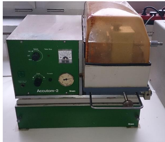
Slika 25. Struers Accutom-2 s vodenim hlađenjem rezalica
