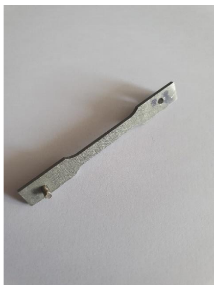
Slika 23. Prikaz pokušaja improviziranog eliminiranja klizanja epruveta iz čeljusti
