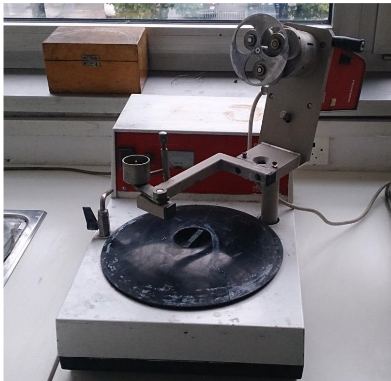
Slika 28. Struers Pedemin stroj za brušenje
