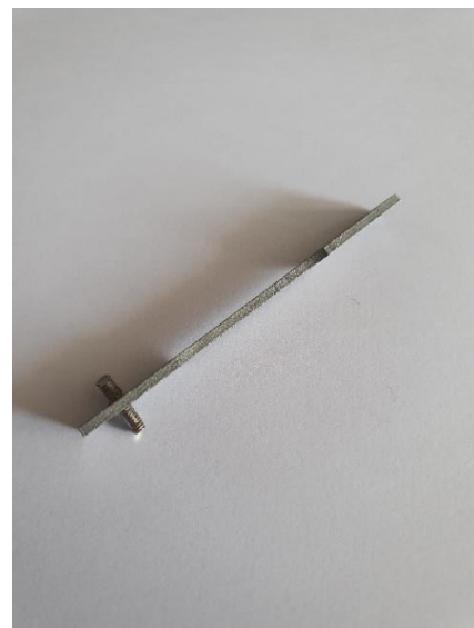
Slika 23. Prikaz pokušaja improviziranog eliminiranja klizanja epruветa iz čeljusti
