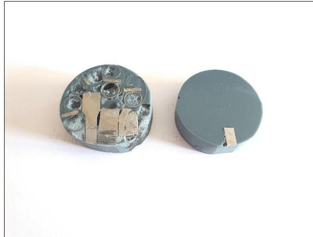
Slika 27. Prikaz ispitnih uzoraka ulivenih u polimernu masu
