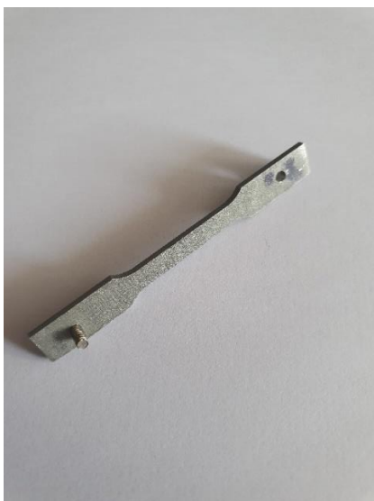
Slika 23. Prikaz pokušaja improviziranog eliminiranja klizanja epruветa iz čeljusti
