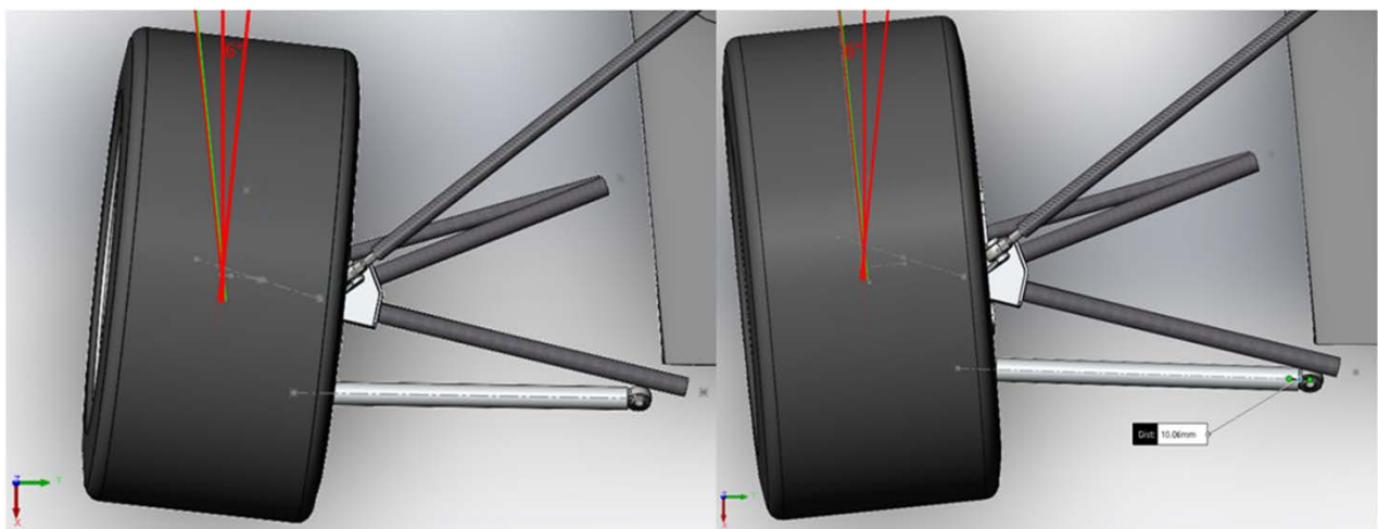
Slika 6.6 Zakret kotača u odnosu na lateralni pomak unutarnjeg prihvata spone
