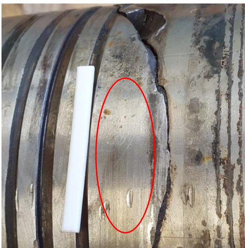
Slika 35. Mjerenje tvrdoće HV10, segment B, blizina pukotine
