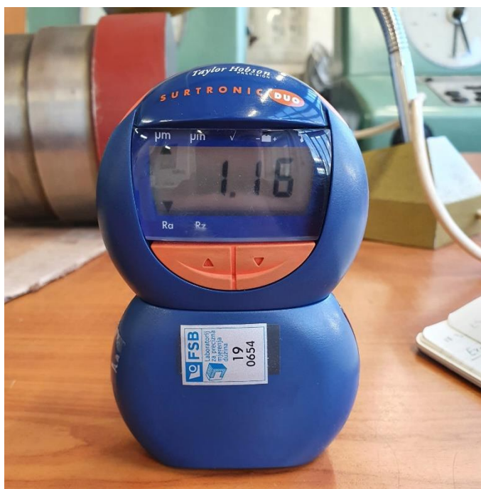
Slika 22. Prijenosni mjerač hrapavosti Taylor Hobson Surtronic DUO
