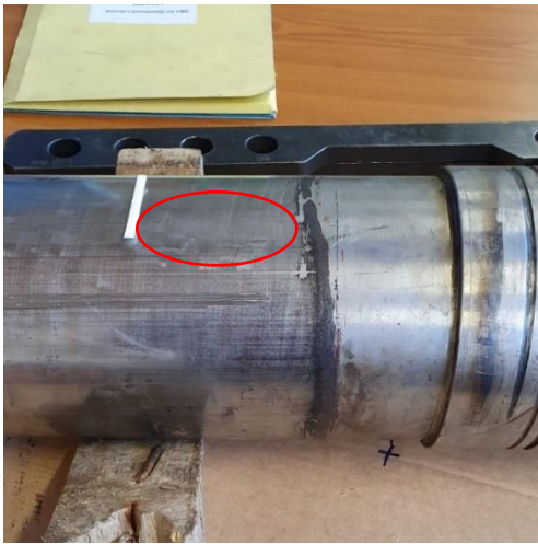
Slika 33. Mjerenje tvrdoće HV10, segment A, referentna površina
