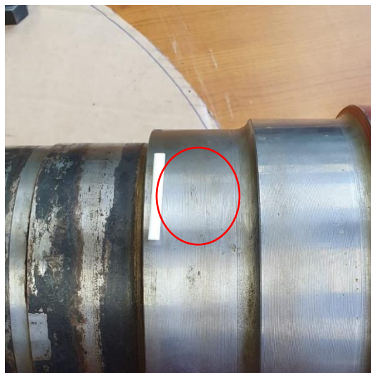
Slika 37. Mjerenje tvrdoće HV10, segment D
