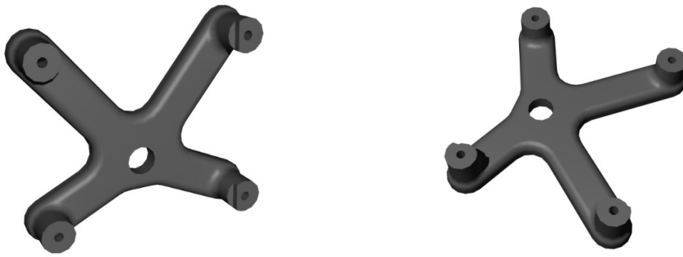
Slika 46. 3D model nosača za Raspberry Pi
