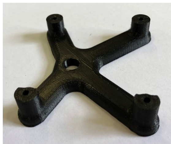
Slika 50. Isprintani nosač za Raspberry Pi
