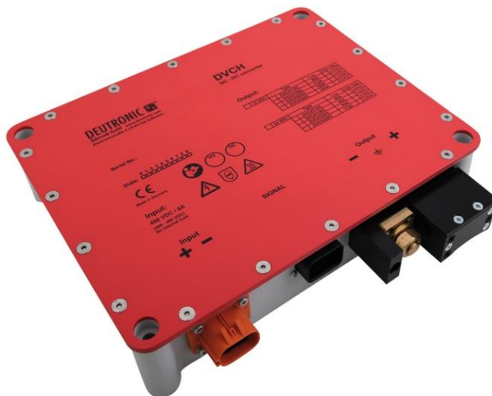
Slika 19. "Buck" DC/DC pretvarač DVCH3003 [18]
