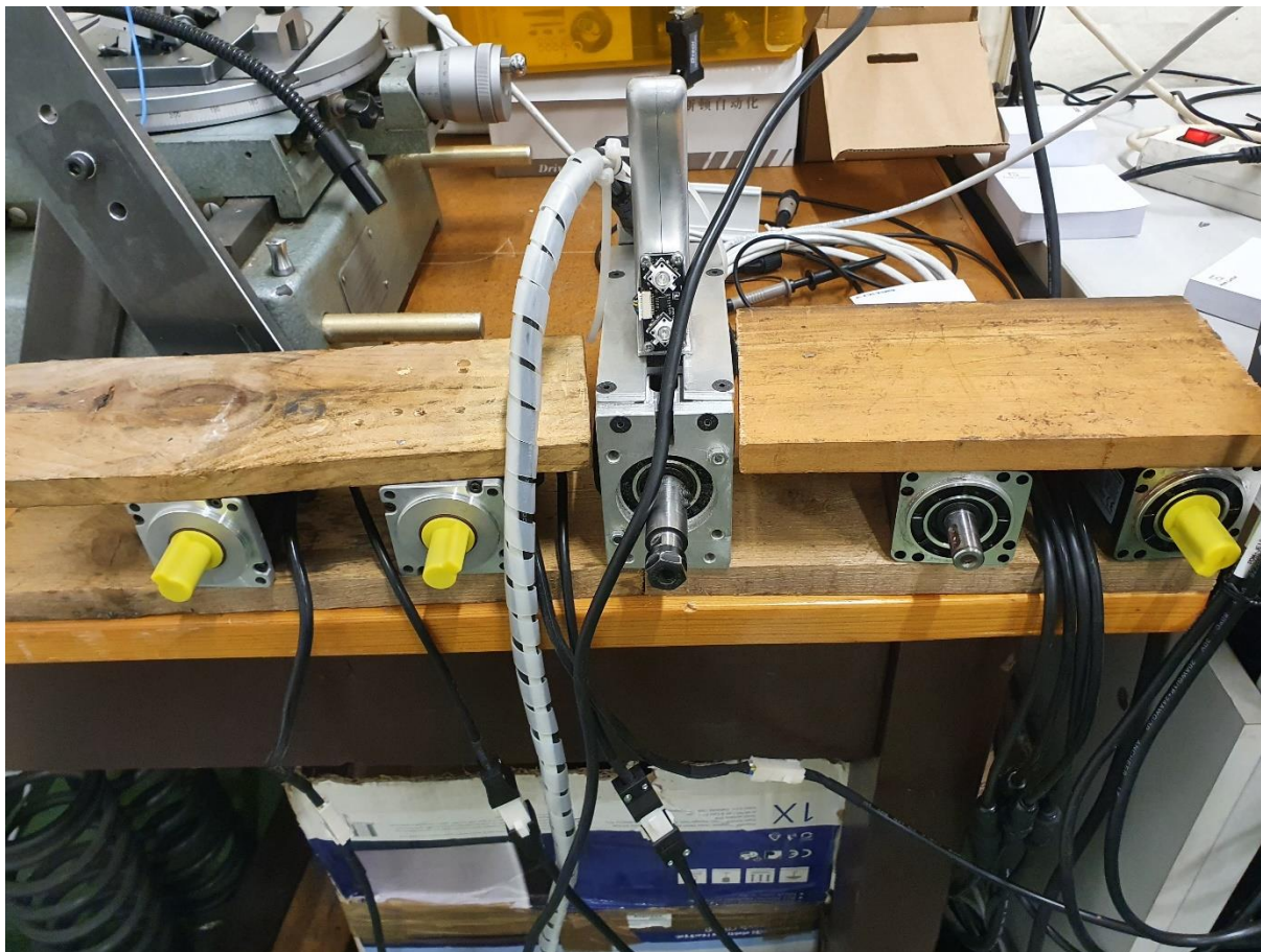
Slika 9. Servo motori korišteni za gibanje osi 3D pisača
