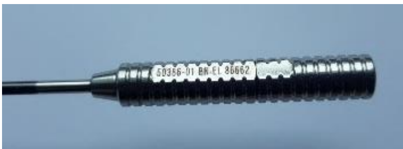
Slika 53. Prikaz brušenih dijelova biopsijske sonde
