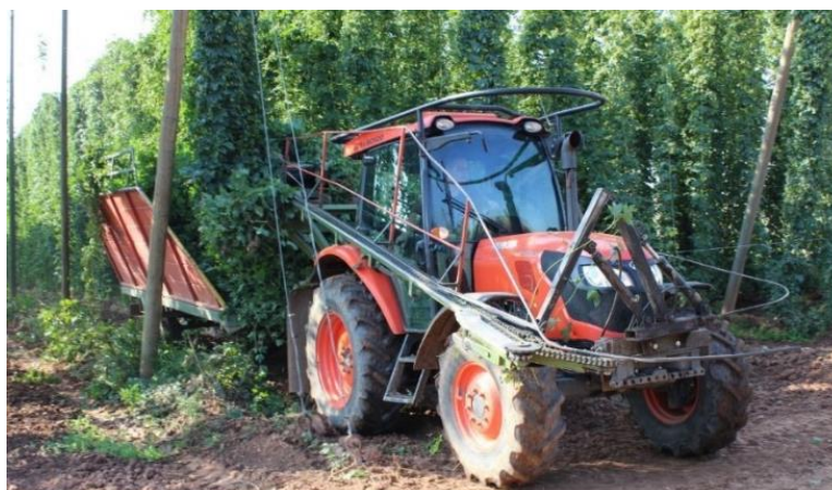
Slika 4. Rezanje stabljike traktorom u Češkoj [26]
