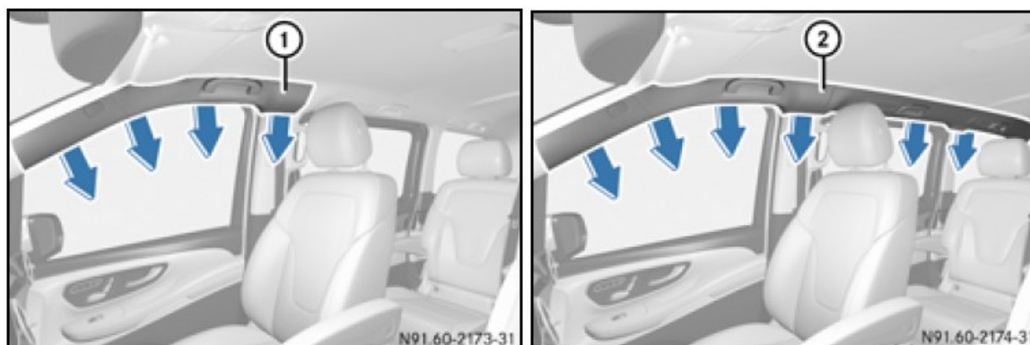
Slika 37. Područja aktivacije: lijevo - A-B stupa, desno - A-D stupa [14]
