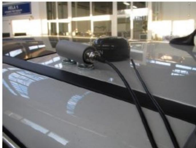
Slika 52. Montirana GPS antena [23]
