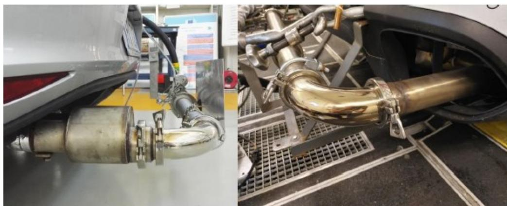
Slika 50. Montirani mjerači masenog protoka ispuha [23]
