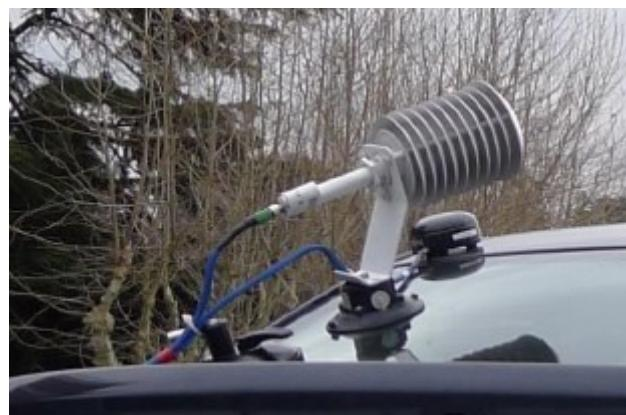
Slika 55. Montirana meteorološka stanica PEMS-a [23]
