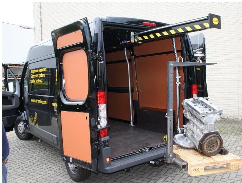
Slika 13. Utovar bloka motora pomoću vitla proizvodača **MAD Tooling** [7]
