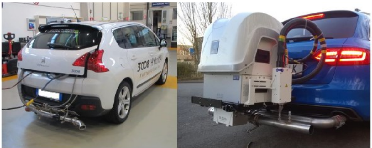
Slika 56. Spajanje grijanog voda za uzorkovanje s PEMS-om [23]
