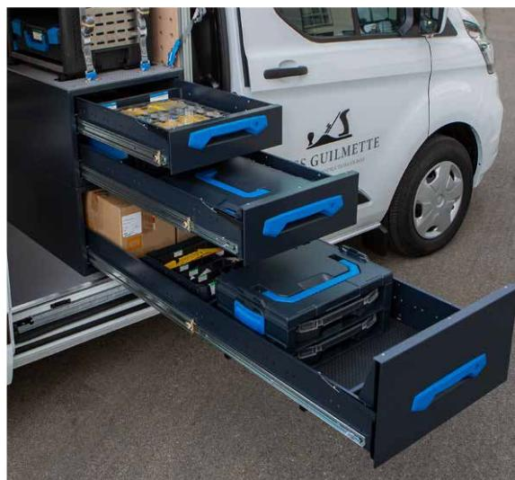
Slika 8. Primjer ladice montirane u vozilo po cijeloj širini proizvođača *Sortimo* [2]
