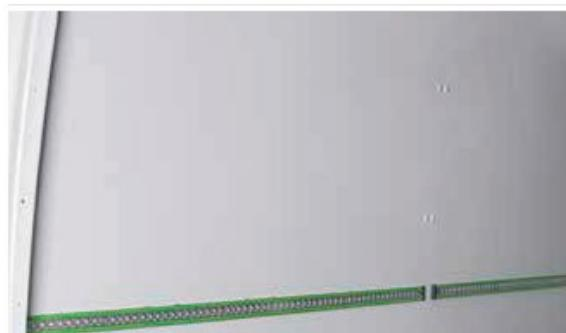
Slika 4. Sidrište ugrađeno na bočne panele proizvođača *bott* [3]
