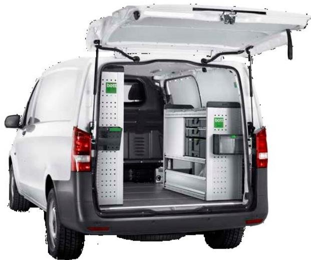
Slika 5. Primjer ugrađenih police u kombi vozilo proizvođača *bott* [3]
