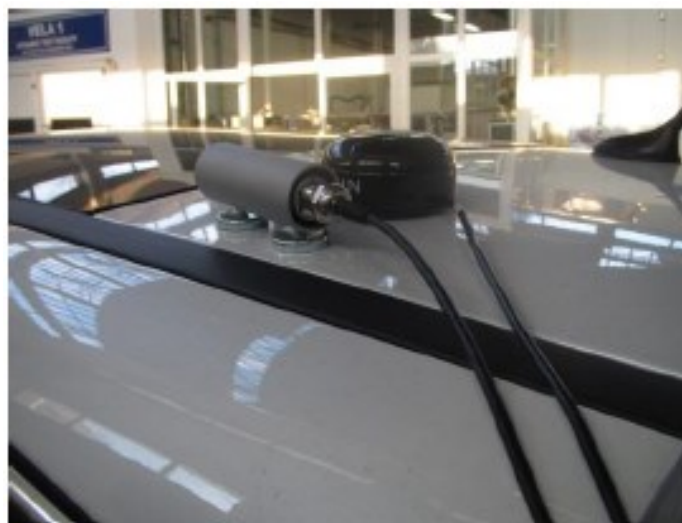
Slika 52. Montirana GPS antena [23]
