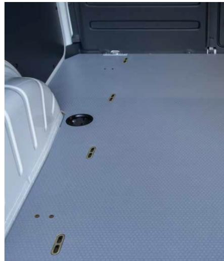
Slika 2. Podnica sa sidrištim proizvođača *Sortimo* [2]
