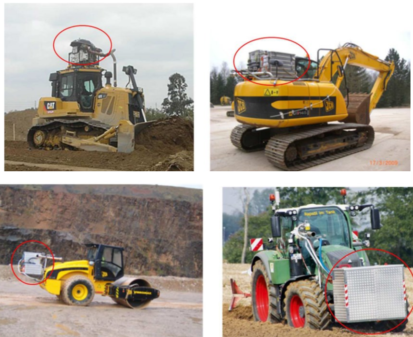
Slika 58. Primjer smještanja PEMS HD uređaja na različite građevinske strojeve [27]
