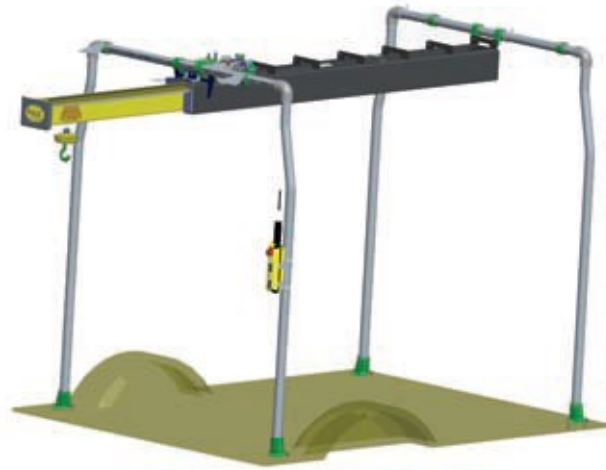
Slika 12. Vitlo za utovar/istovar teškog tereta proizvođača MAD Tooling [6]
