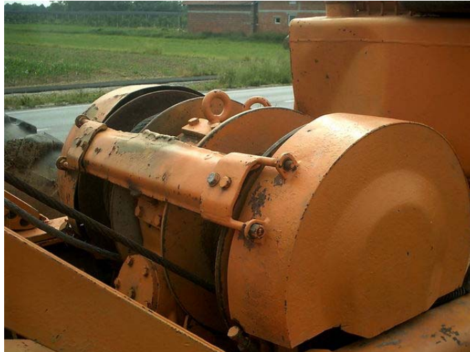
Slika 24: Dvobubanjno vitlo šumskog traktora
