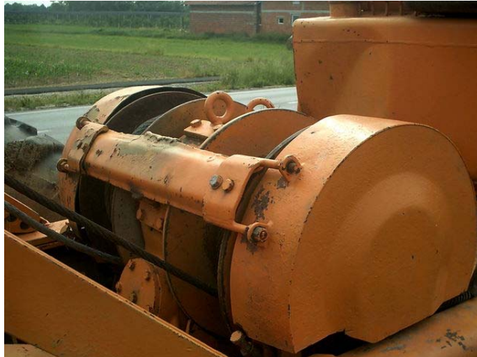
Slika 24: Dvobubanjno vitlo šumskog traktora
