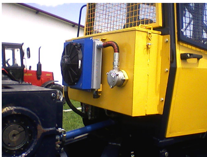
Slika 90: Vitlo – spremnik hidrauličke tekućine s hladnjakom
