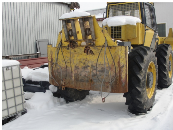
Slika 93: Novorazvijeni traktor EcoTRAC 120MV nakon 605 sati probnog rada – stražnja naletna ploča s vodilicama užadi
