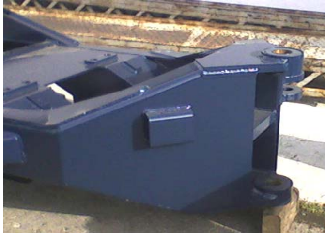
Slika 27: Stražnja polušasija – pogled na vertikalni zglob
