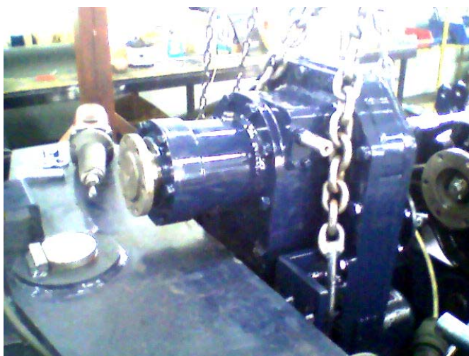
Slika 82: Motaža razvodnika pogona
