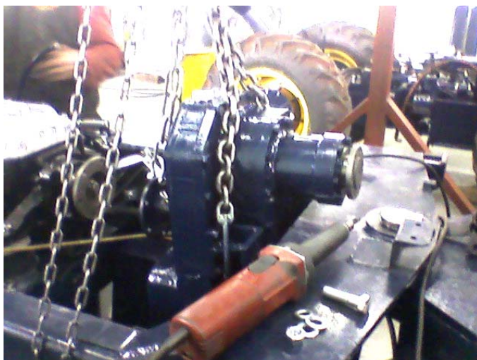
Slika 81: Motaža razvodnika pogona
