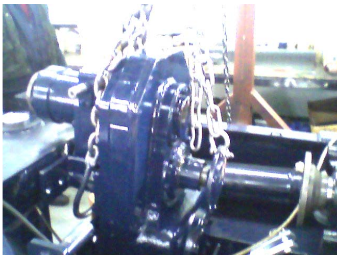
Slika 80: Motaža razvodnika pogona
