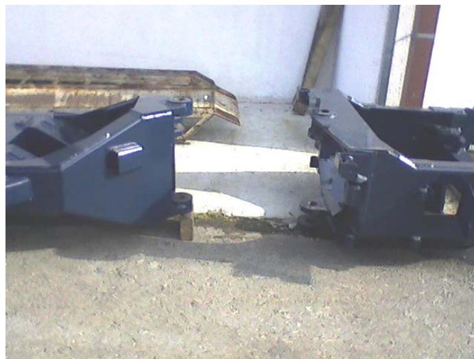
Slika 28: Rastavljena šasija – pogled na vertikalni zglob
