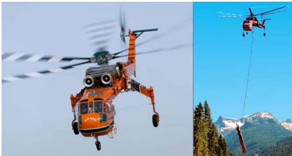
Slika 12: Transport trupaca helikopterom pomoću užetnog vitla
