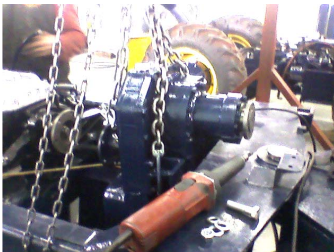
Slika 81: Motaža razvodnika pogona
