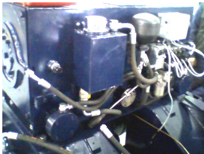
Slika 88: Vitlo – hidraulički sustav
