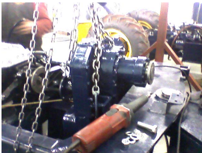
Slika 81: Motaža razvodnika pogona
