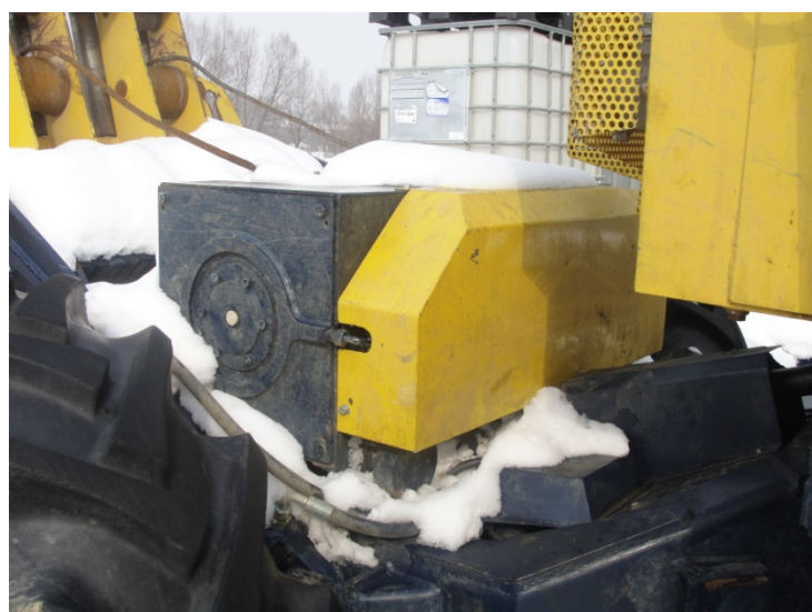
Slika 94: Novorazvijeni traktor EcoTRAC 120MV nakon 605 sati probnog rada – vitlo (žuti zaštitni poklopac hidrauličkog sustava i plavi zaštitni lim kardanskog vratila), užad u vodilicama (gore lijevo), kabina (gore desno)
