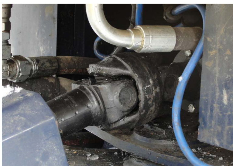
Slika 96: Novorazvijeni traktor EcoTRAC 120MV nakon 605 sati probnog rada – dvostruki kardanski zglob na izlazu razvodnika pogona
