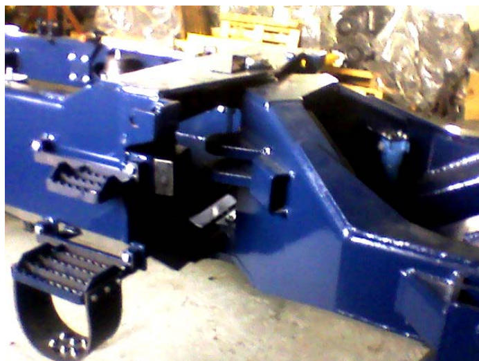
Slika 29: Spoj šasije u vertikalnom zglobu
