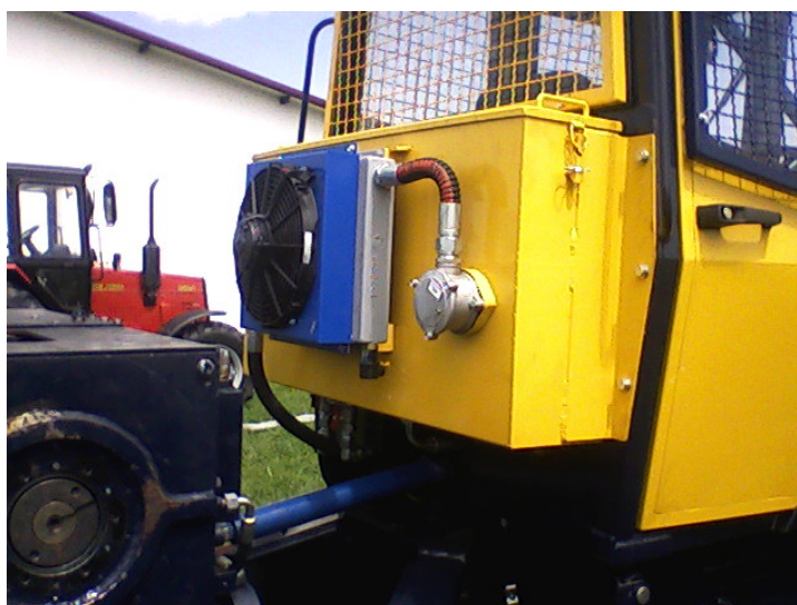
Slika 90: Vitlo – spremnik hidrauličke tekućine s hladnjakom
