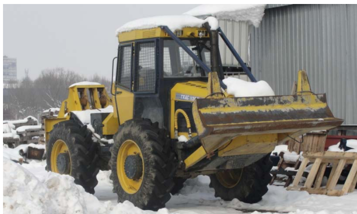
Slika 92: Novorazvijeni traktor EcoTRAC 120MV (mehanički pogon vitla) nakon 605 sati probnog rada
