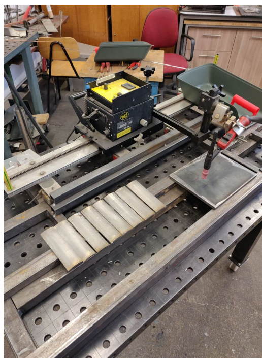
Slika 12. "BUG-O systems" automat za zavarivanje
