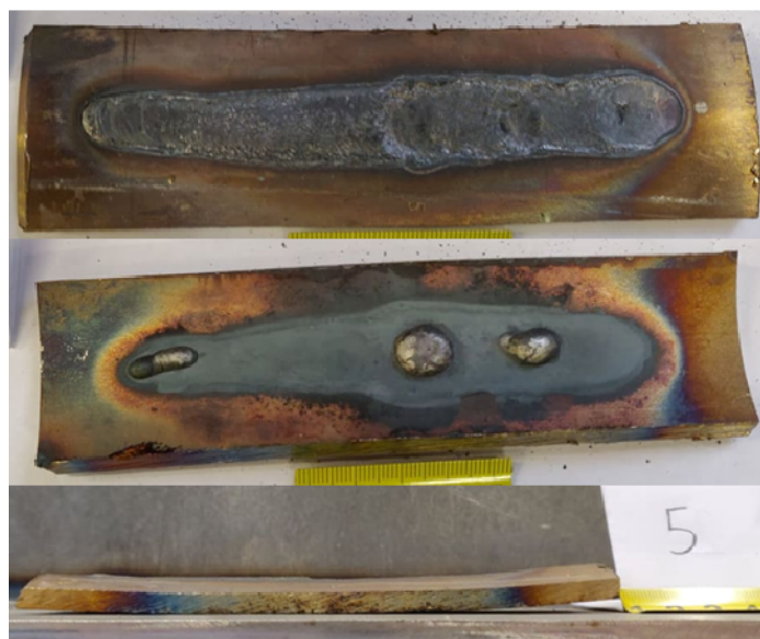
Slika 19. Uzorak 5 ( I = 175 \text{ A} , U = 14,6 \text{ V} )
