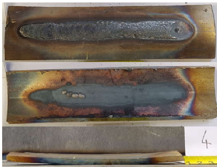
Slika 18. Uzorak 4 ( I = 150 \text{ A} , U = 14 \text{ V} )
