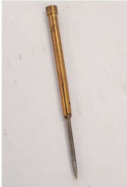
Slika 10. Volframova netaljiva elektroda
