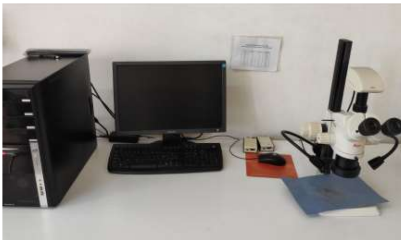
Slika 24. Mikroskop Leica MZ6
