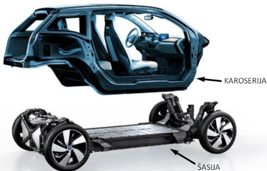
Slika 32. Šasija i karoserija BMW i3 automobila [22]
