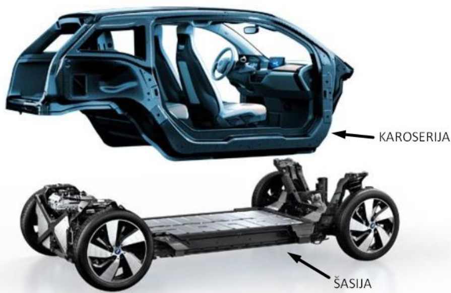
Slika 32. Šasija i karoserija BMW i3 automobila [22]
