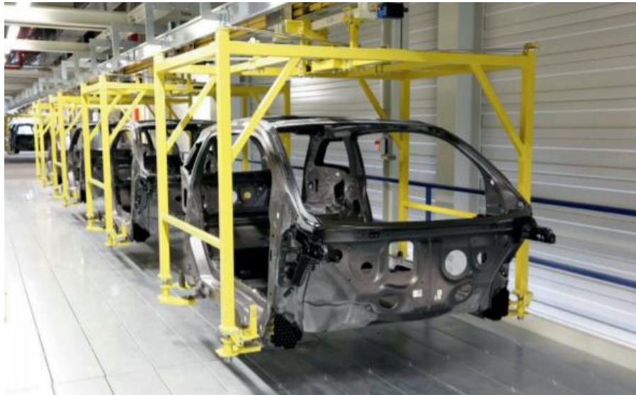
Slika 33. Automatizirana proizvodnja karoserije BMW i3 od CFRP-a u Leipzigu [21]
