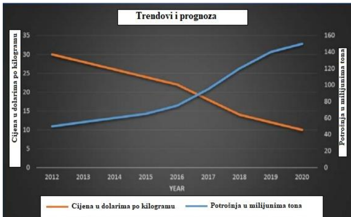
Slika 29. Prikaz porasta potrošnje i pada cijene ugljičnih vlakana [18]
