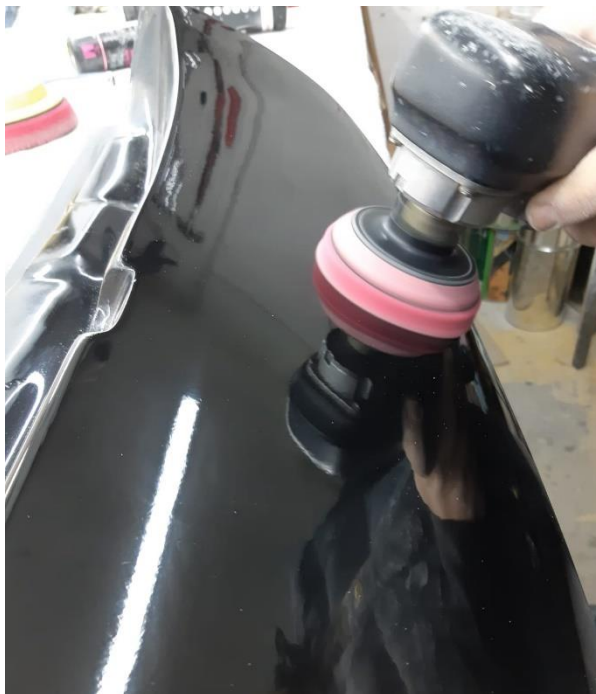
Slika 43. Poliranje spojlera uređajem za poliranje
