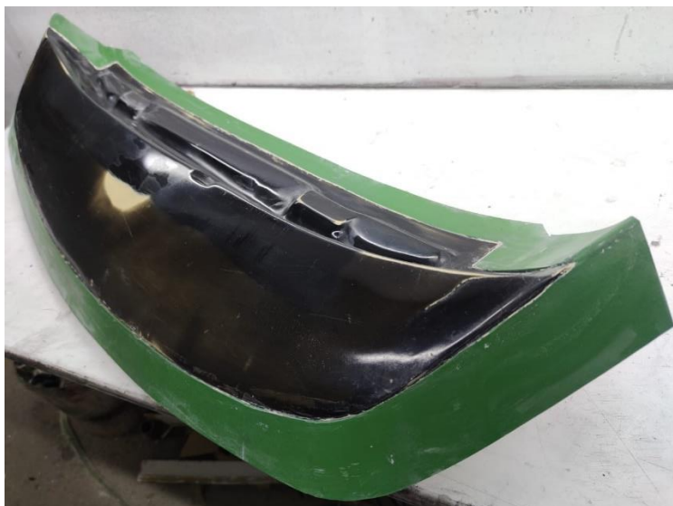
Slika 32. Donja strana prototipa spremna za laminiranje
