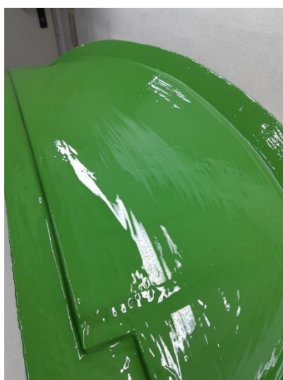
Slika 28. Gornja površina modela spojlera prekrivena premazom gela
