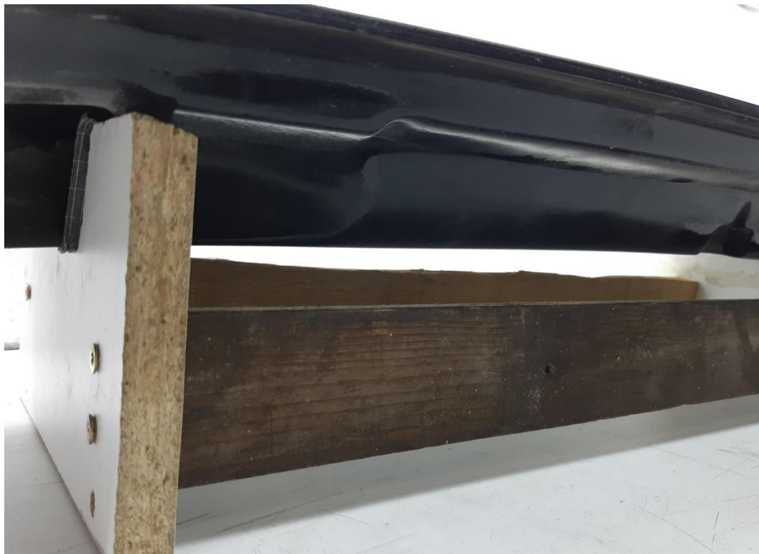
Slika 23. Naprava za pričvršćivanje prototipnog spojlera tijekom rada
