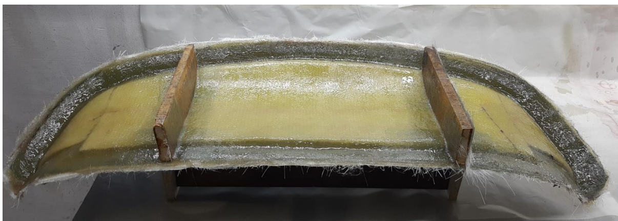
Slika 31. Završen gornji dio kalupa
