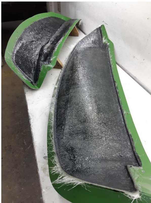
Slika 38. Završena laminacija za otpresak
