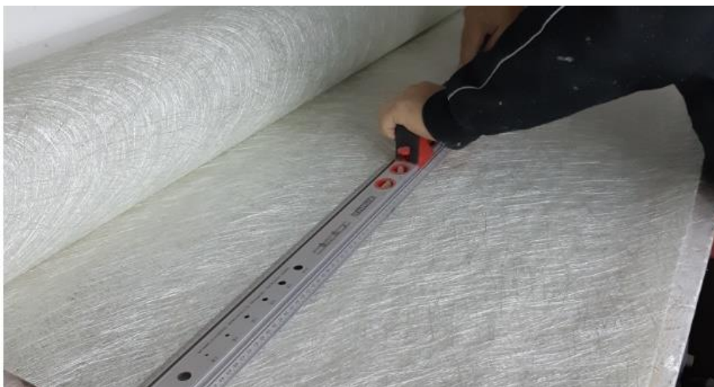
Slika 14. Rezanje staklenih vlakana
