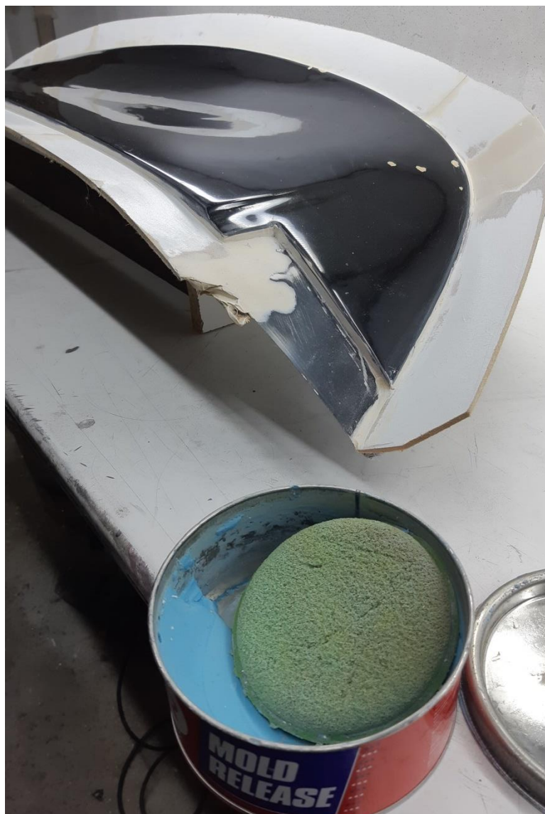
Slika 26. Nanošenje voska na gornju površinu spojlera
