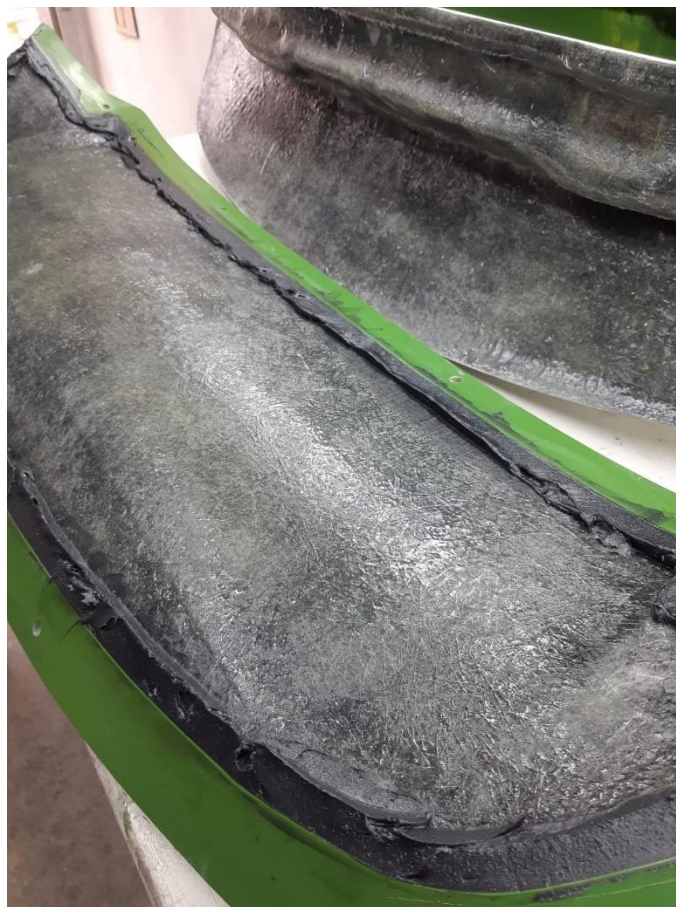
Slika 40. Umetanje otpreska natrag u kalup
