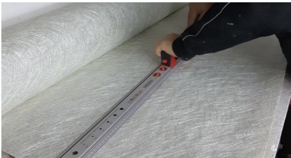
Slika 14. Rezanje staklenih vlakana
