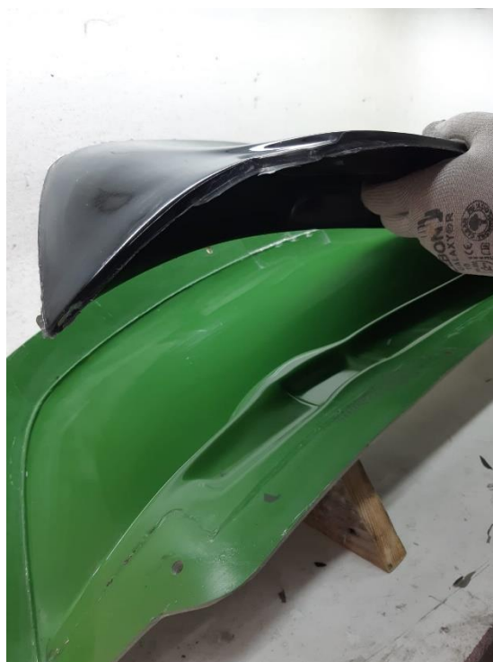
Slika 42. Vađenje spojlera iz kalupa
