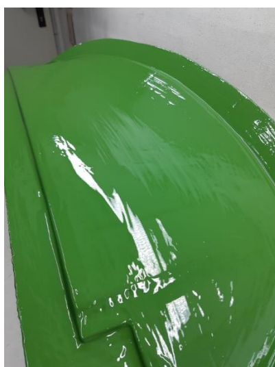
Slika 28. Gornja površina modela spojlera prekrivena premazom gela
