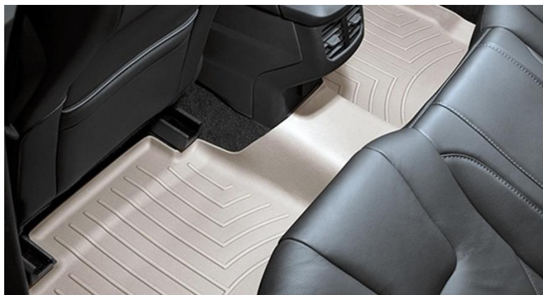
Slika 8. Tepih u Ford Lincolnu od polimernog kompozita ojačanog vlaknima banane [17]
