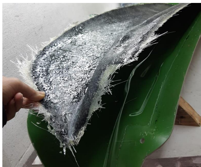
Slika 39. Vađenje otpreska iz kalupa
