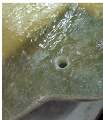
b) provrt za vijak na prirubnici
