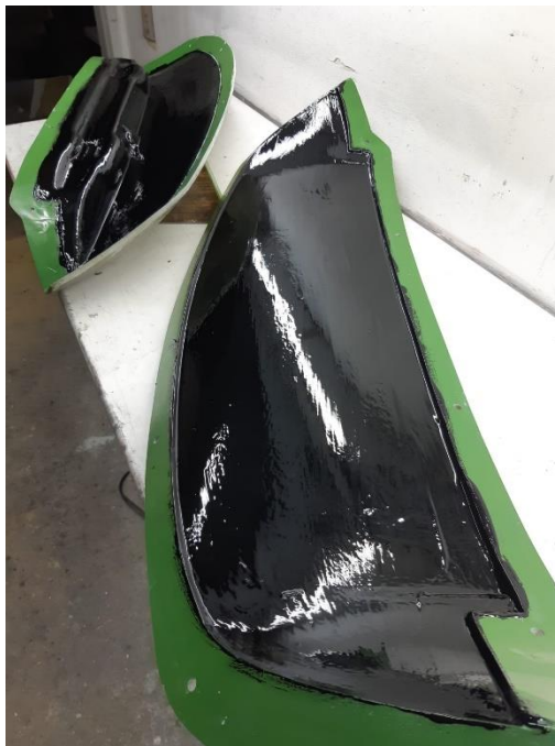
Slika 37. Nanošenje crnog gel premaza na kalup
