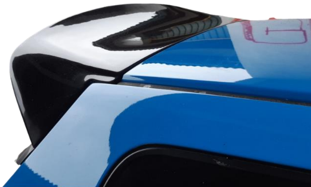
Slika 47. Izrađeni krovni spojler montiran na automobil Honda Civic EG
