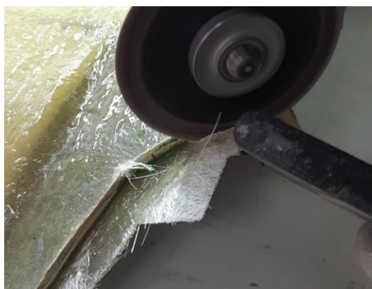
a) rezanje rubova kalupa
