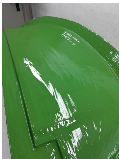
Slika 28. Gornja površina modela spojlera prekrivena premazom gela
