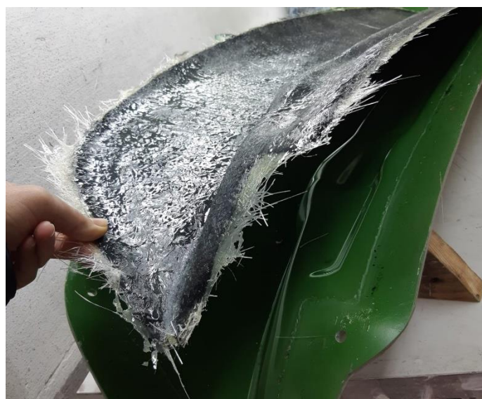
Slika 39. Vađenje otpreska iz kalupa
