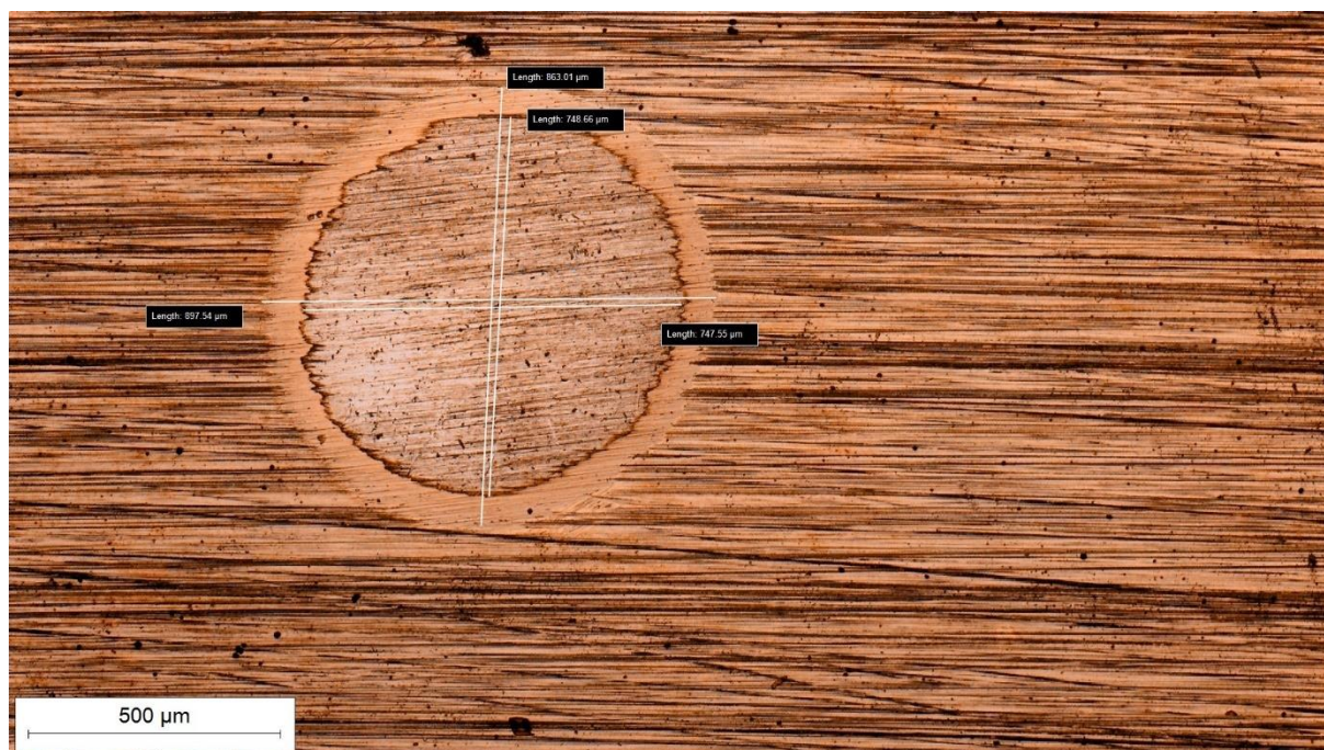
Slika 37. Trag trošenja na čeliku K390 MC snimljen na svjetlosnom mikroskopu nakon ispitivanja debljine prevlake metodom utiskivanja kuglice na uzorku C3 s TiN/TiBN prevlakom
