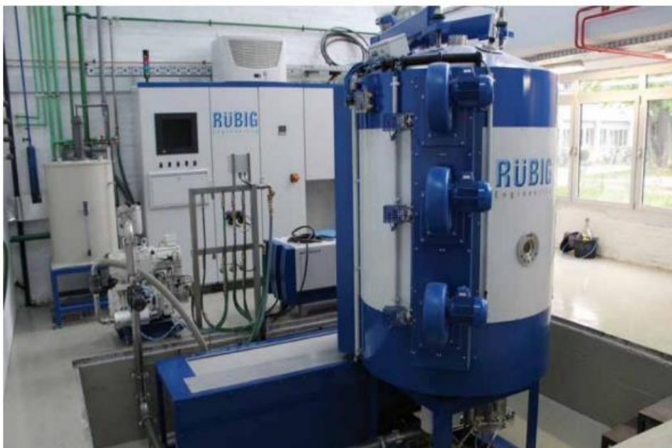
Slika 9. PACVD uređaj tvrtke RUBIG instaliran na Fakultetu strojarstva i brodogradnje[8]
