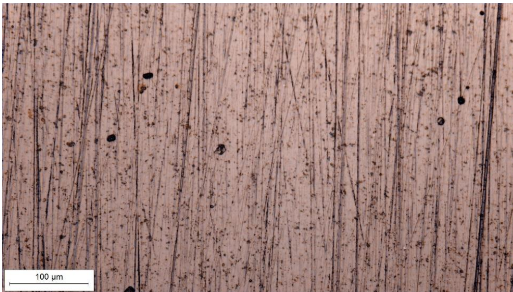
Slika 42.. Trošene površine uzoraka C2 od čelika K390 MC snimljene na svjetlosnom mikroskopu
