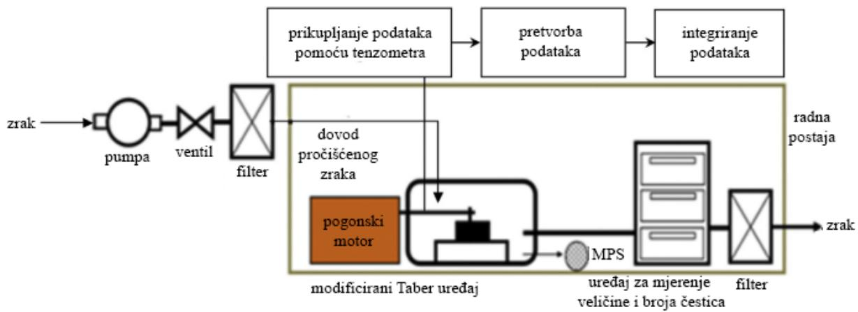
**Slika 47. Shema procesa ispitivanja modificiranim Taber uređajem [16].**
