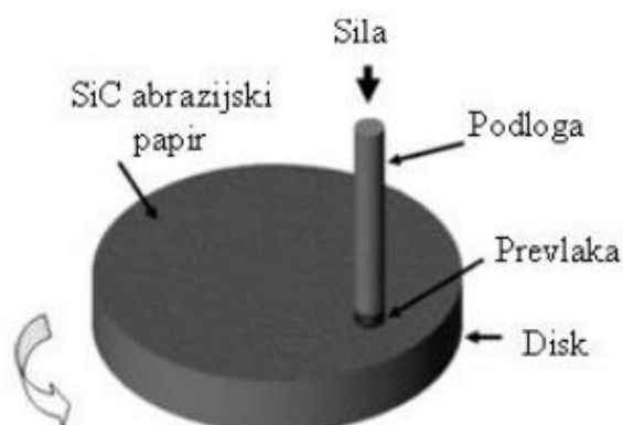
Slika 27. Ispitivanje valjčić po disku [12]
