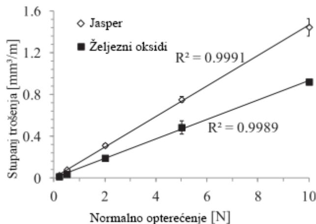
**Slika 34.** Linearno povećanje trošenja povećanjem opterećenja [14].
