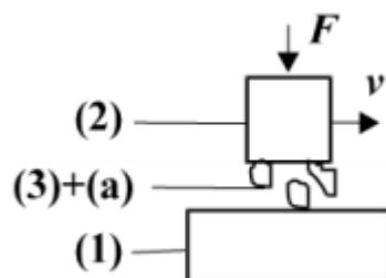
**Slika 43. Shema abrazijskog trošenja, gdje je: (1) - funkcionalni dio, (2) - funkcionalni dio, (3) - međusredstvo (mazivo), (a) – abraziv, F – sila, N, v – brzina, m/s [1].**
