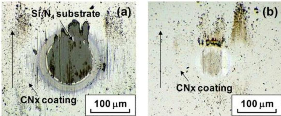
Slika 24. Izgled istrošene površine kuglice bez (a) i sa uhodavanjem (b) [11].
