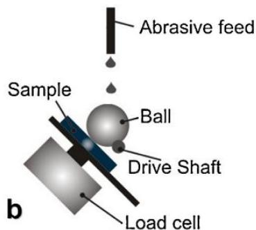
**Slika 50. Shema metode ispitivanja trošenja sa slobodnom kuglom [17].**
