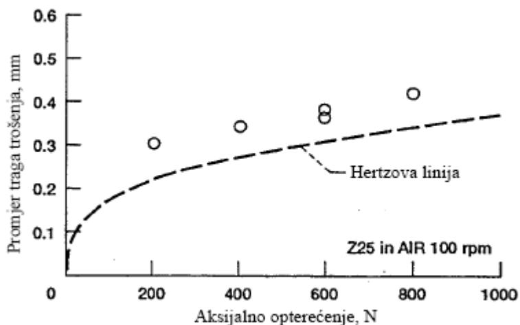
Slika 12. Podaci o trošenju ovisno o aksijalnom opterećenju [7].
