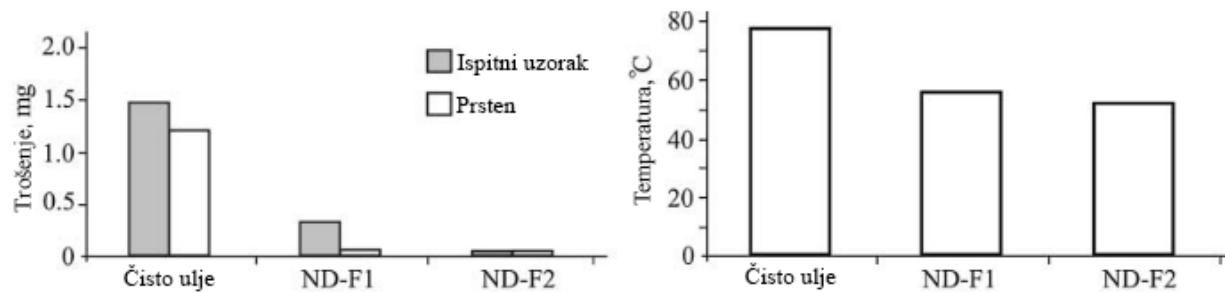
Slika 17. Rezultati trošenja i smanjenja temperature za 0,01% ND ulja SAE 10W [9].
