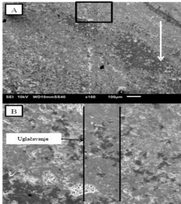
**Slika 31. Oštećenje na hematitu i getitu te nastalo uglačavanje [14].**
