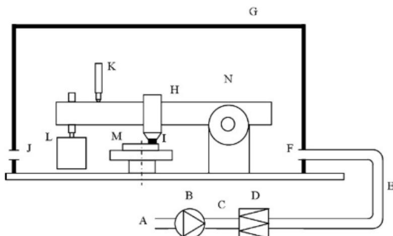
**Slika 28. Shema ispitivanja trošenja čestica kočenja, (A) zrak prostorije, (B) ventilator, (C) mjerač protoka zraka, (D) filter zraka, (E) savitljiva cijev, (F) ulaz u komoru, (G) komora, (H) uređaj valjčić po disku, (I) valjčić, (J) izlaz iz komore, (K) osjetnik pomicanja, (L) uteg, (M) rotirajući disk, (N) zrak unutar komore [13].**
