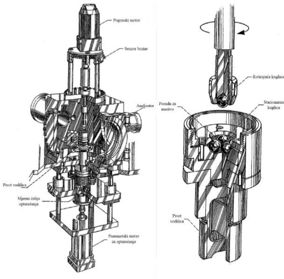
Slika 11. Shema tribouredaja 4 kuglice korištenog u vakuumskom ispitivanju [7].
