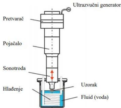
**Slika 53. Hielscherov uređaj za ispitivanje kavitacijskom erozijom [18].**
