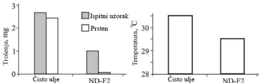
Slika 18. Rezultati trošenja i smanjenja temperature u vrsti ispitivanja 3 za 0,01% ND ulja I 20A [9].
