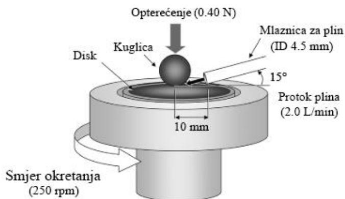
Slika 22. Prilagođeni tribouredaj „kuglica po disku“ s jedinicom za dovod plina [11].
