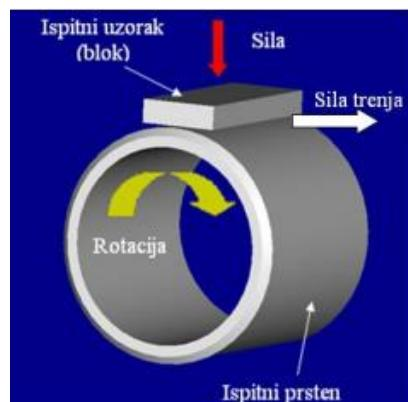
**Slika 14.** Shema ispitivanja „prizma po prstenu“ [8].
