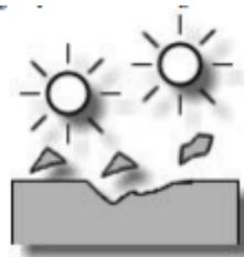
Slika 52. Shema tribosustava kavitacijske erozije [1].
