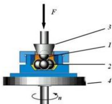
**Slika 8. Shema uređaja „4 kuglice“ za klizno ispitivanje [5]**
