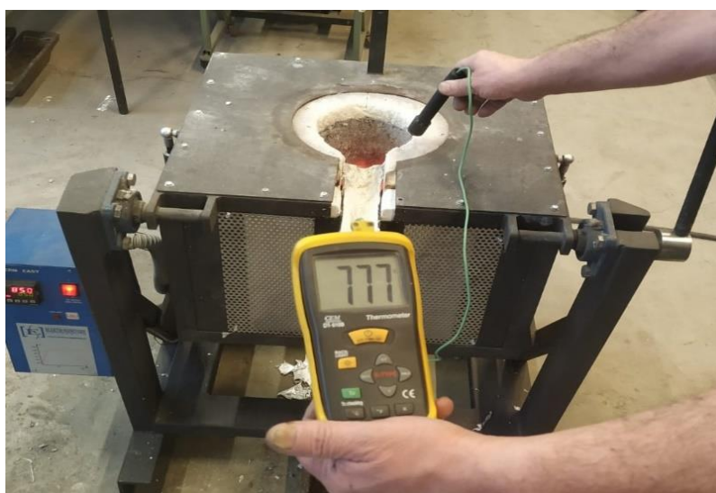
Slika 43. Mjerenje temperature taljevine pirometrom
