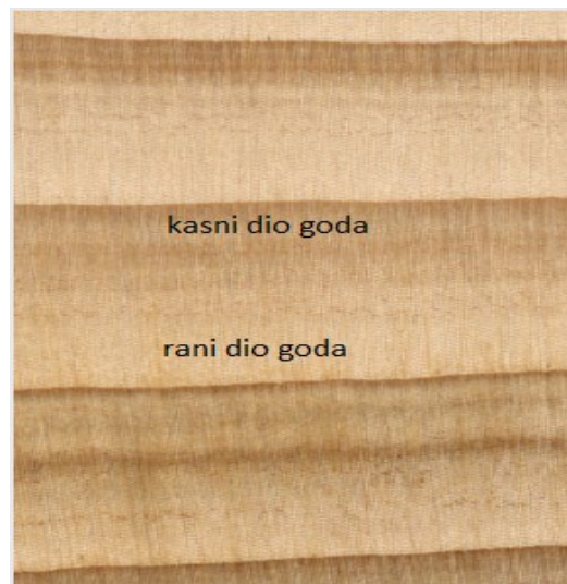
Slika 2.8 Kasni i rani dio goda na poprečnom presjeku, [9]
