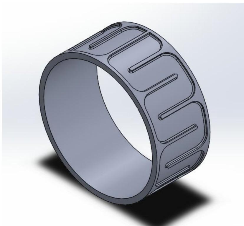
Slika 2-6 Koncept vodene košuljice korištene za hlađenje elektromotora bolida RT07
