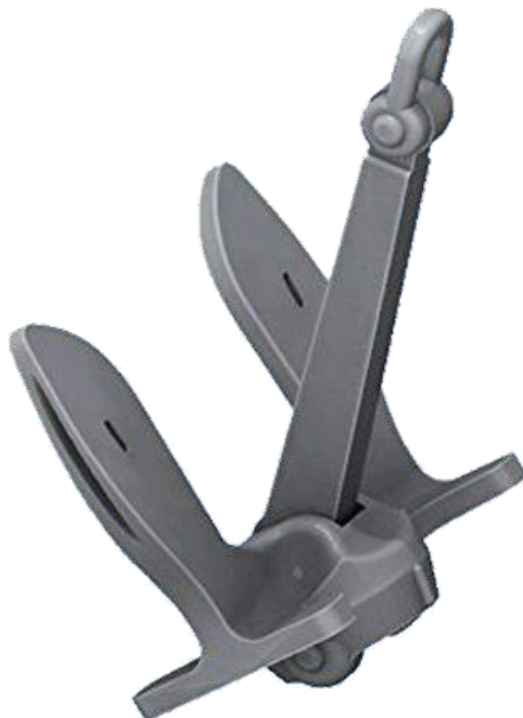
Slika 5-1 Sidro bez prečke [11]
