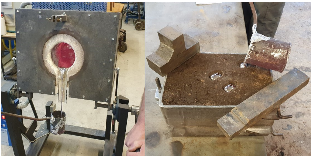
Slika 43. Izlijevanje iz peći i ulijevanje u kalup
