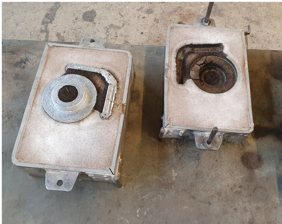
Slika 44. Otvoreni kalup s odljevkom
