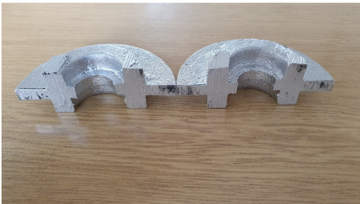
Slika 56. Poprečni presjek odljevka od legure AlSi7Mg
