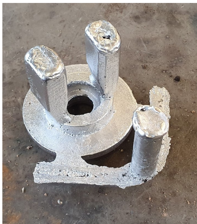
Slika 45. Odljevak s uljevnim sustavom
