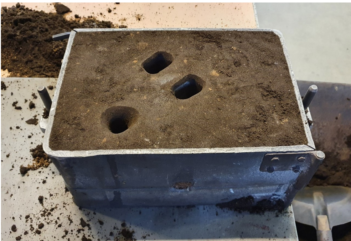
Slika 35. Izrada uljevne čaše i skošavanje rubova pojila
