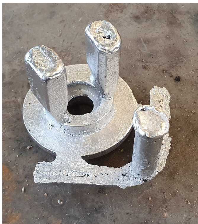
Slika 45. Odljevak s uljevnim sustavom
