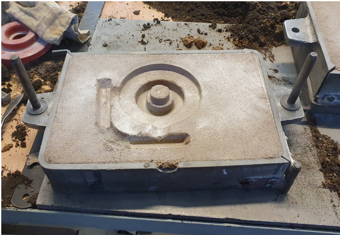
Slika 38. Donjak bez modela, s izrađenim ušćima i spojenim razvodnicima
