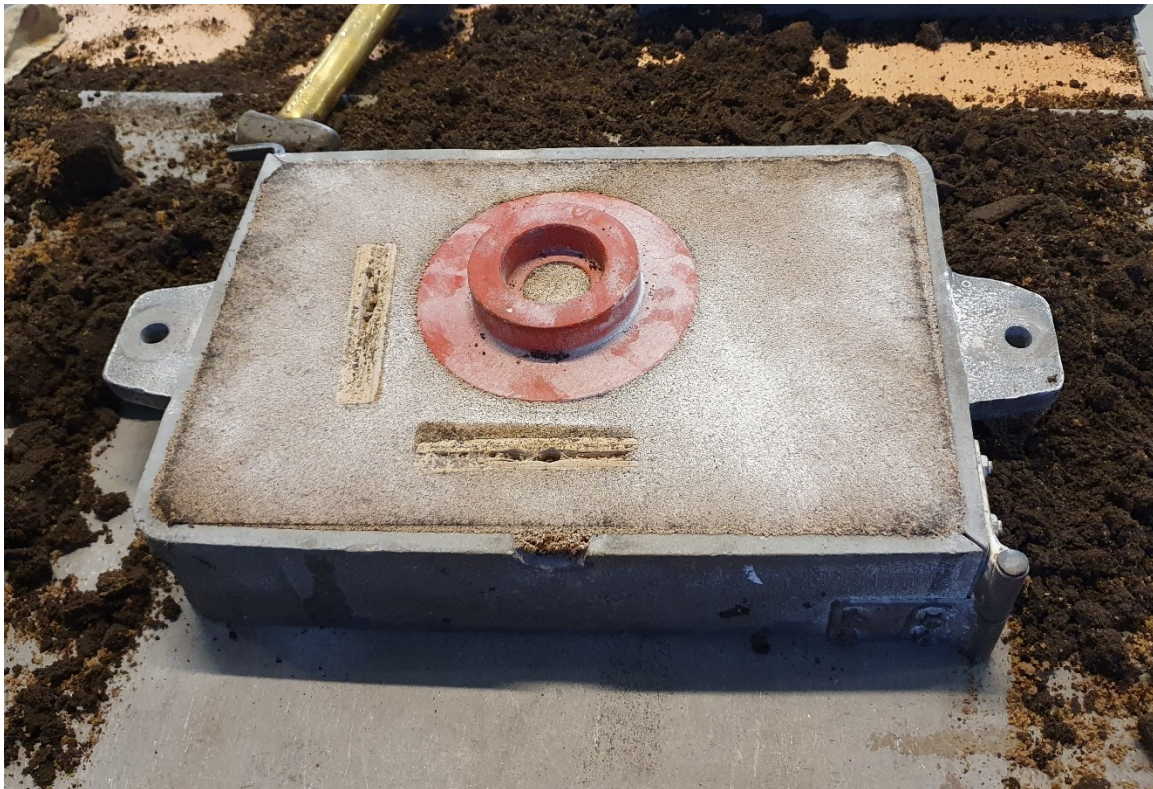
Slika 30. Pozicija razvodnika i modela u donjaku
