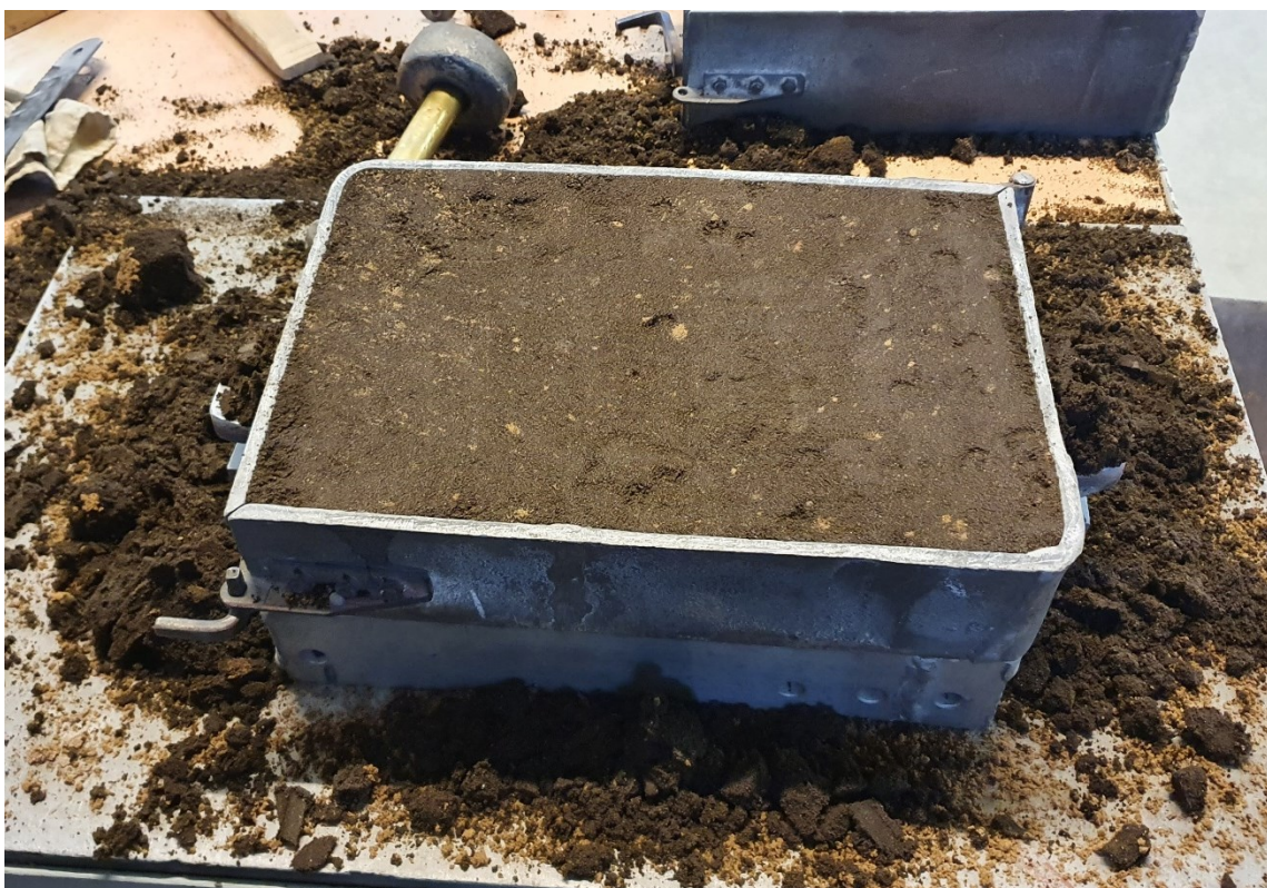
Slika 29. Donjak nakon sabijanja i poravnavanja kalupne mješavine
