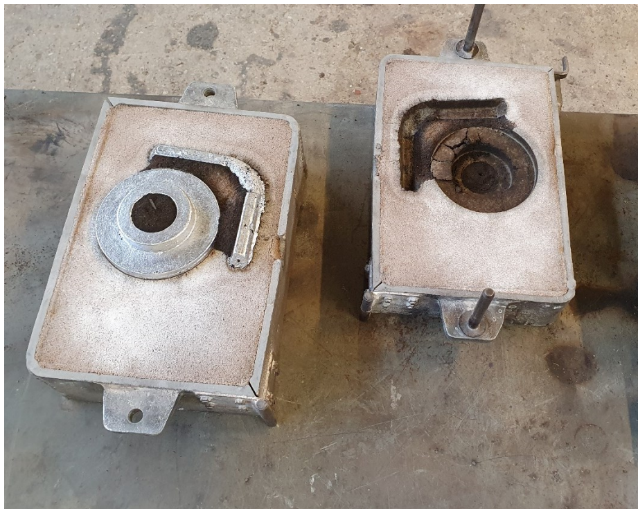
Slika 44. Otvoreni kalup s odljevkom
