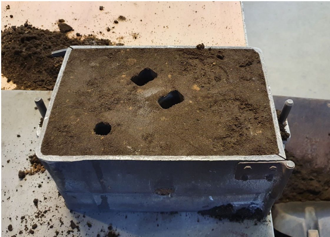
Slika 34. Gornjak nakon vađenja spusta i pojila
