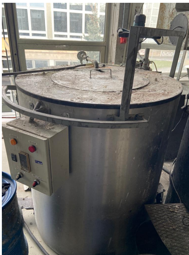
Slika 17. Jamska peć za naknadnu oksidaciju
