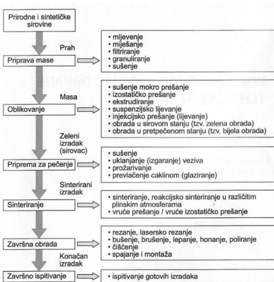
Slika 2.2 Dijagram tijeka proizvodnje keramičkih materijala [1]
