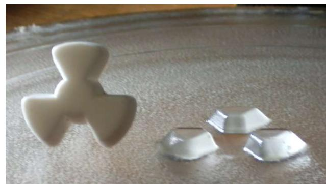
Slika 1.9 Kandžasta spojka u mikrovalnoj pećnici
