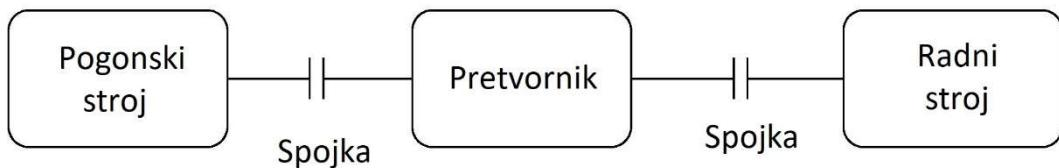
**Slika 1.1 Shematski prikaz mehaničkog sustava**
