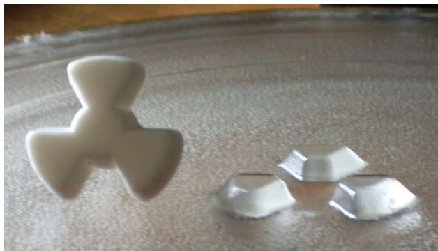
Slika 1.9 Kandžasta spojka u mikrovalnoj pećnici
