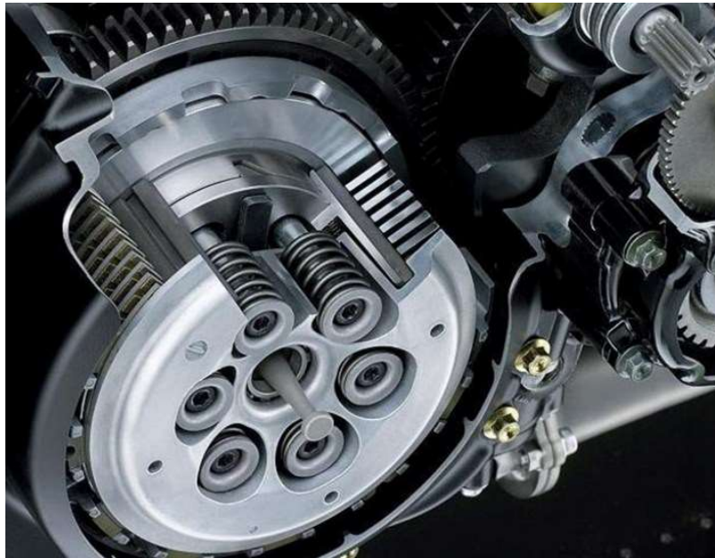
Slika 1.4 Lamelna spojka na motociklu
