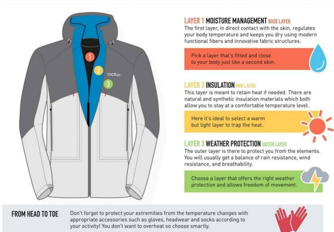
Slika 2.38 Slojevi u skijaškom odijelu [49]
