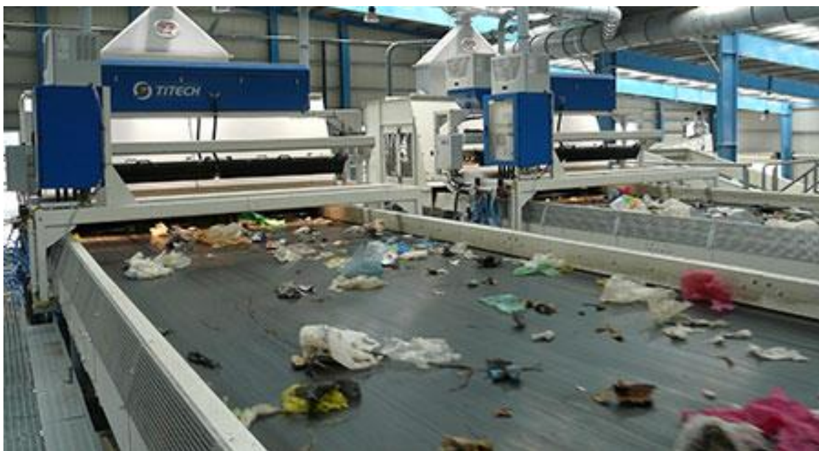
Slika 12. Uredaj za infracrveno sortiranje [24]
