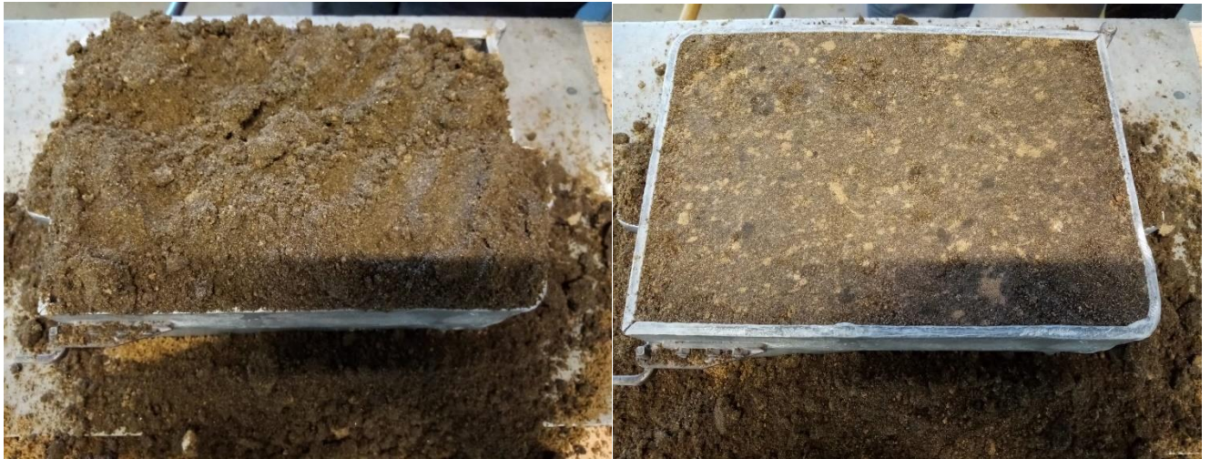
Slika 55. Dodavanje punidbene kalupne mješavine i njeno poravnavanje
