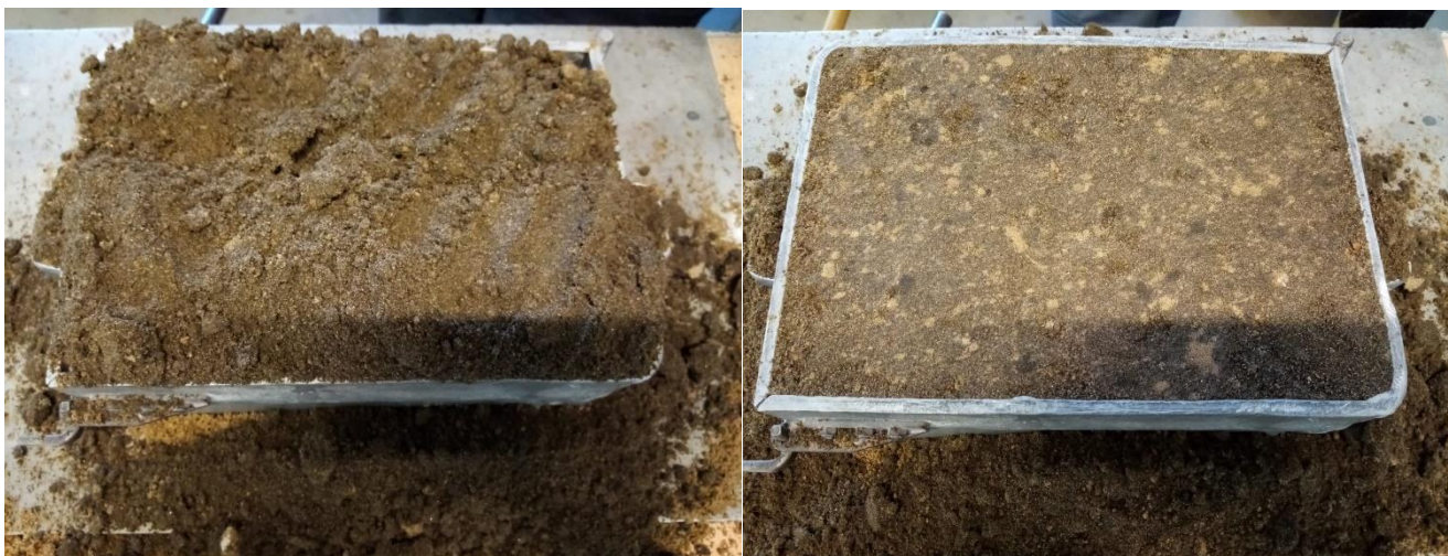
Slika 55. Dodavanje punidbene kalupne mješavine i njeno poravnavanje
