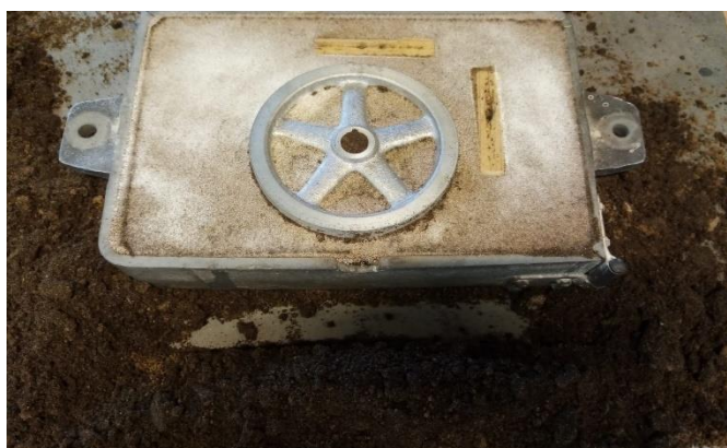
Slika 56. Model odljevka i razvodnik u donjaku
