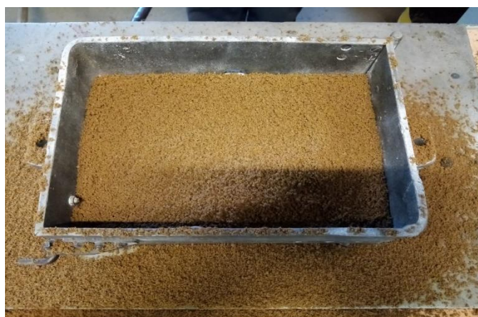
Slika 54. Zasipavanje donjaka modelnom kalupnom mješavinom
