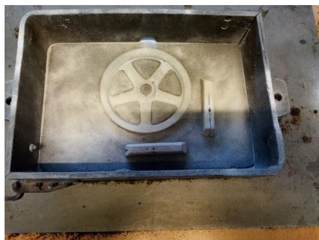
Slika 53. Zasipavanje donjaka prahom radi lakšeg vađenja modela
