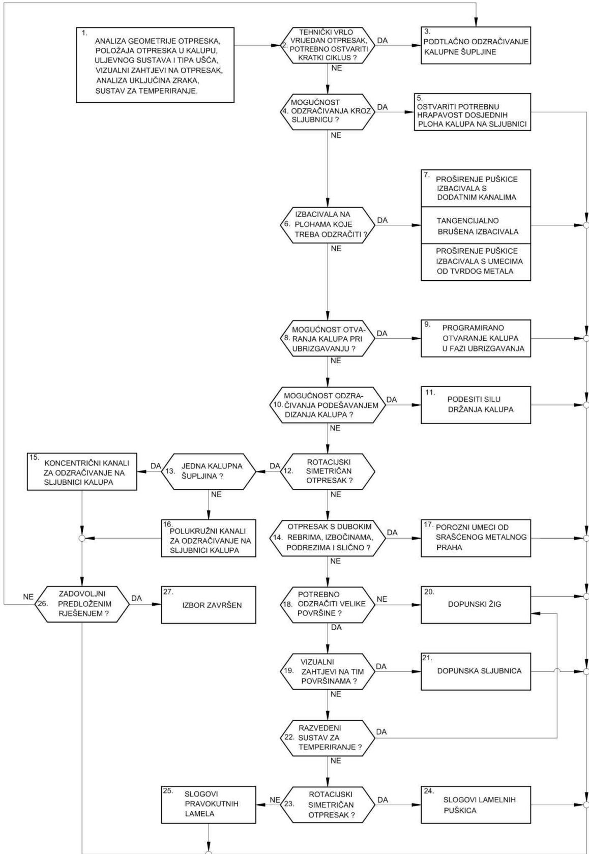
Slika 3.10. Dijagram za načelno određivanje sustava za odzračivanje kalupa<sup>5</sup>
