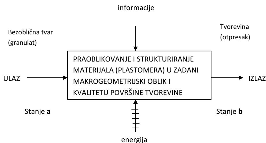
Slika 3.1. Apstraktna definicija kalupa za injekcijsko prešanje plastomera<sup>10</sup>
