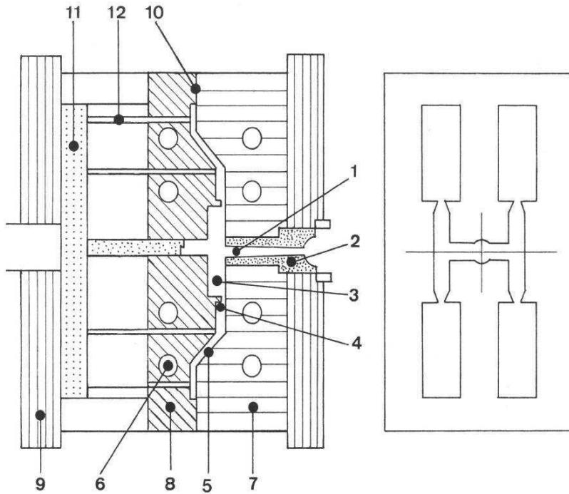
Slika 2.3 Kalup za injekcijsko prešanje<sup>7</sup>
