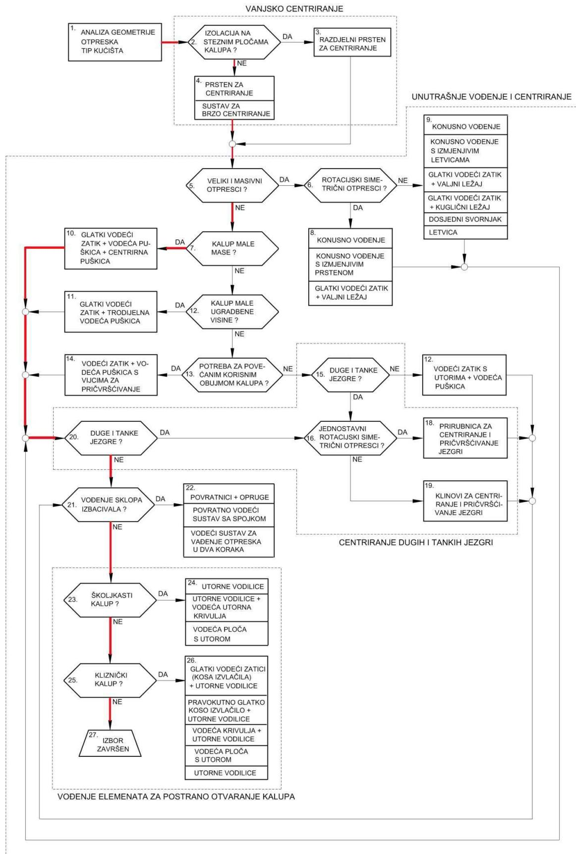
Slika 5.7. Dijagram za načelno određivanje sustava za vođenje i centriranje<sup>5</sup>
