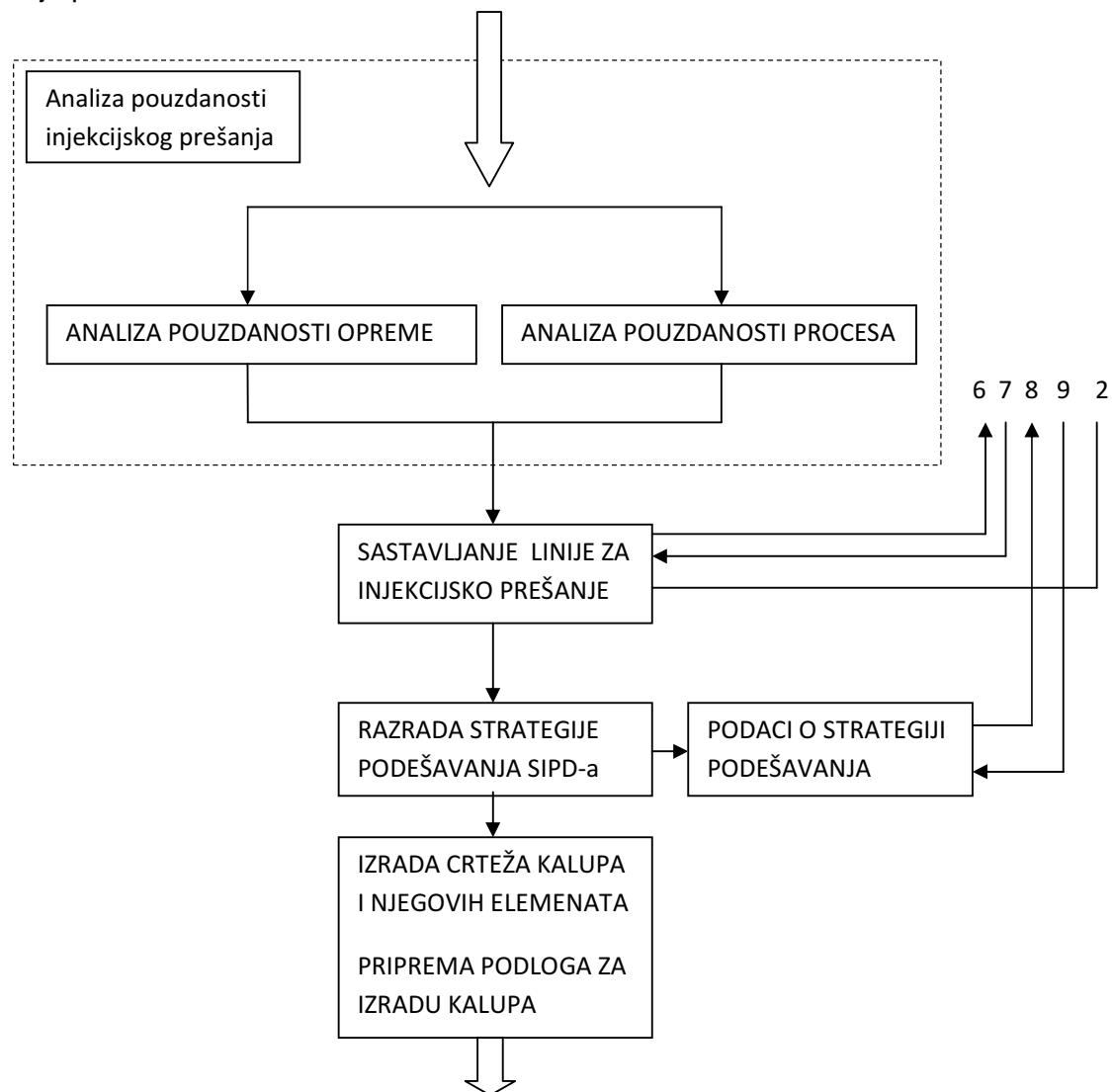
Slika 3.14. Razrada faze završnih aktivnosti konstruiranja kalupa za injekcijsko prešanje<sup>9</sup>
