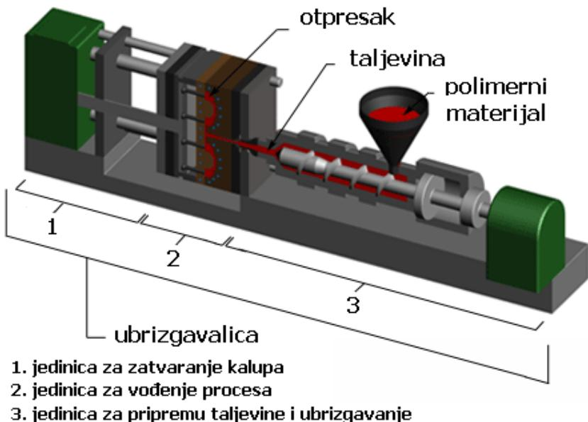
Slika 2.2. Sustav za injekcijsko prešanje<sup>3</sup>
