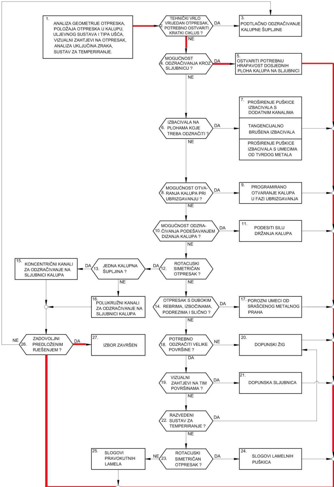
Slika 5.9. Dijagram za načelno određivanje sustava za odzračivanje kalupa<sup>5</sup>
