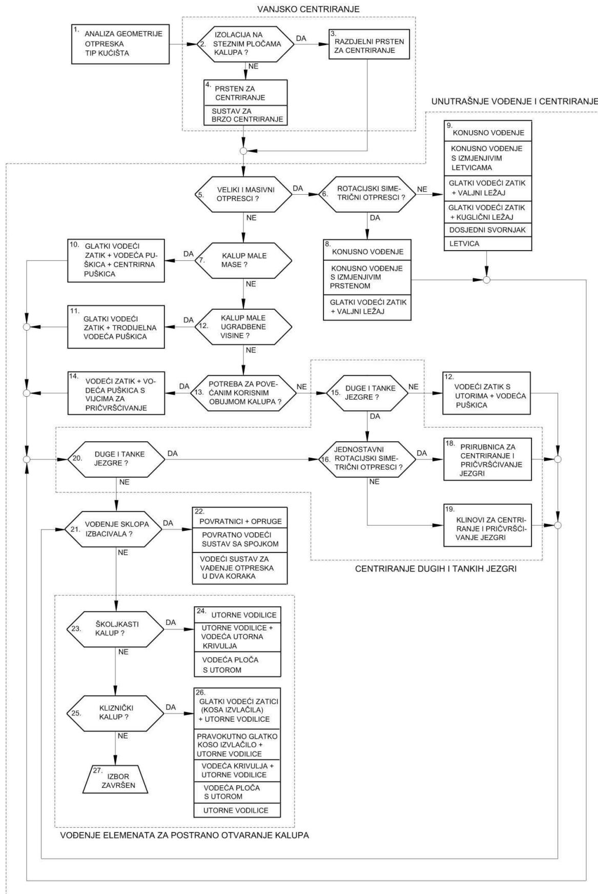
Slika 3.9. Dijagram za načelno određivanje sustava za vođenje i centriranje<sup>5</sup>
