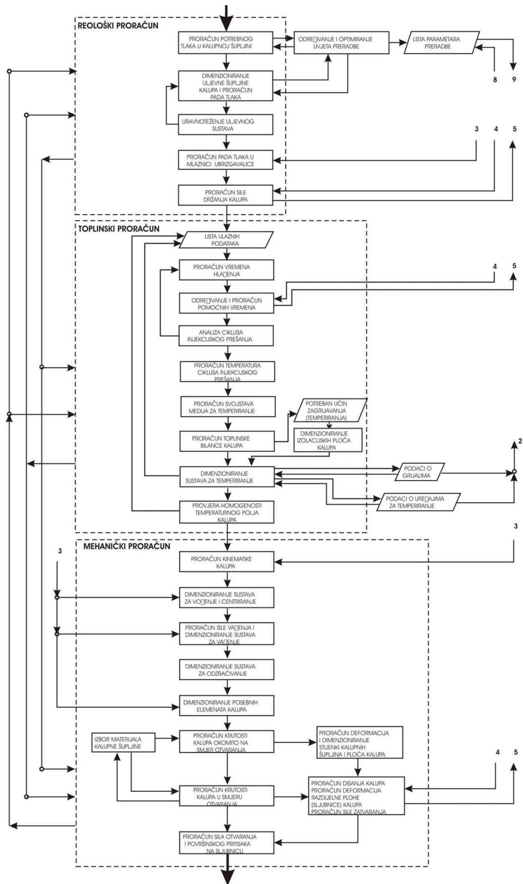
Slika 3.11. Aktivnosti dimenzioniranja elemenata kalupa<sup>5</sup>
