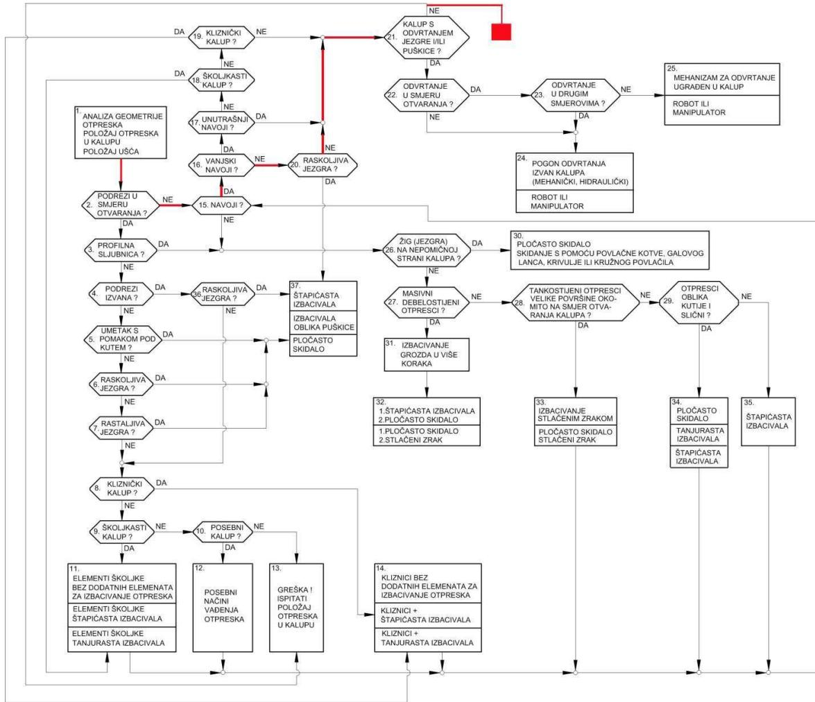
Slika 5.8. Dijagram za načelno određivanje sustava za vađenje grozda iz kalupa<sup>5</sup>
