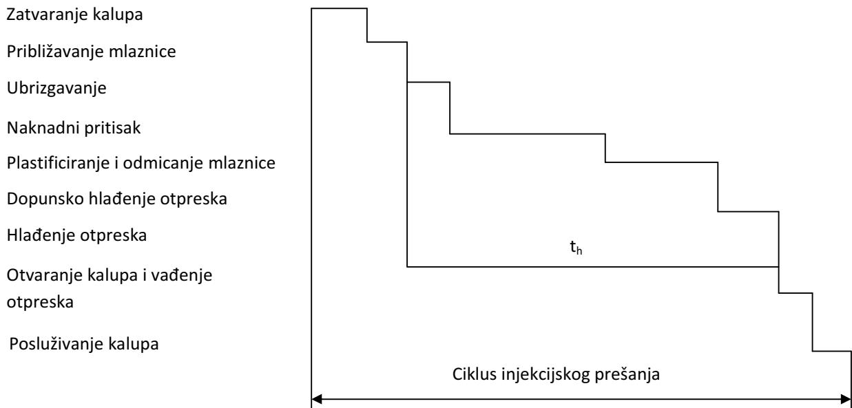
Slika 3.13. Faze ciklusa injekcijskog prešanja plastomera<sup>9</sup>
