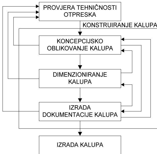
Slika 3.2. Temeljne faze metodičkoga konstruiranja kalupa za injekcijsko prešanje plastomera<sup>10</sup>
