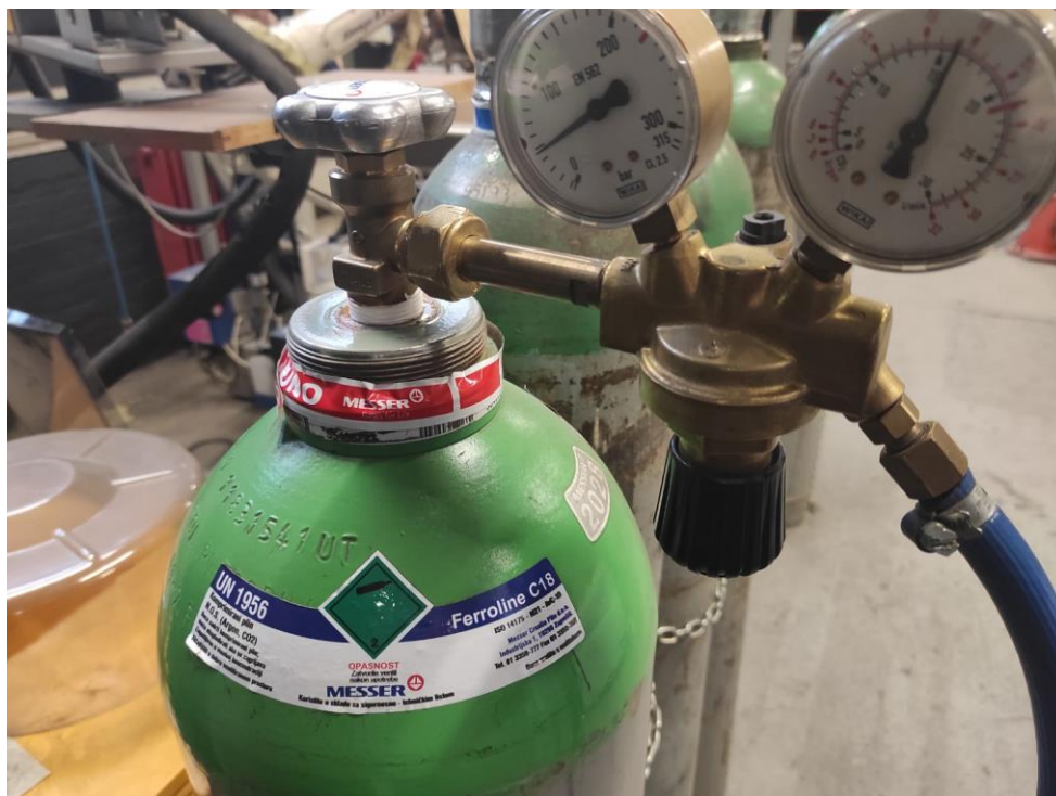
Slika 41. Čelična boca s zaštitnim plinom
