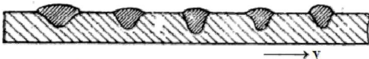
Slika 19. Utjecaj brzine zavarivanja na oblik zavara [11]
