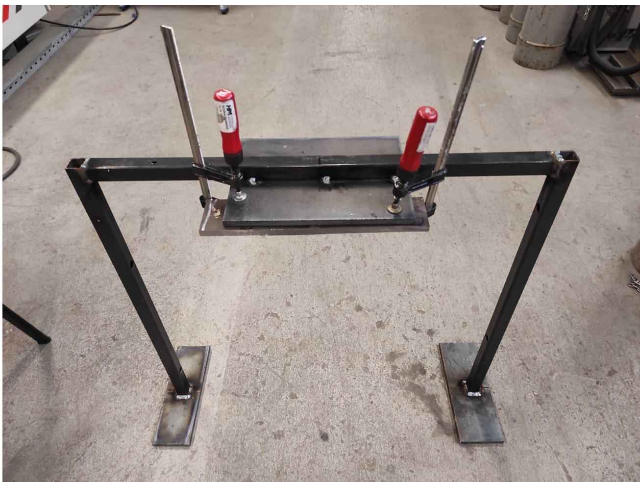
Slika 42. Postolje za nadglavno zavarivanje
