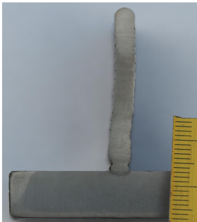
Slika 51. Makroizbrusak nakon brušenja i nagrivanja
