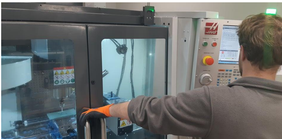
Slika 7.24. Prikaz obrade pleksiglasa na CNC stroju, Haas VF-4
