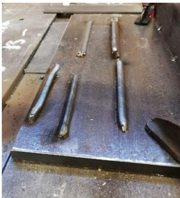
Slika 13. Probe izrade kosih zidova različitim parametrima zavarivanja
