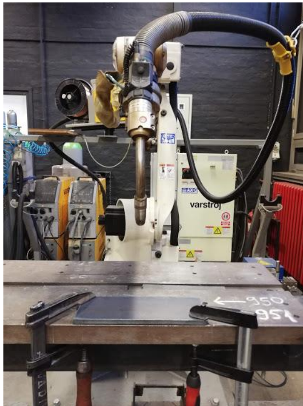
Slika 16. Početni položaj pištolja i učvršćena podloga za zavarivanje
