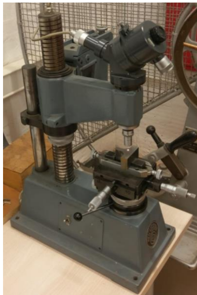
Slika 27. Uređaj za mjerenj tvrdoće
