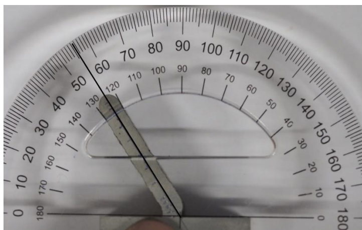
Slika 21. Očitavanje kuta drugog zida nazivnog kuta 45^\circ
