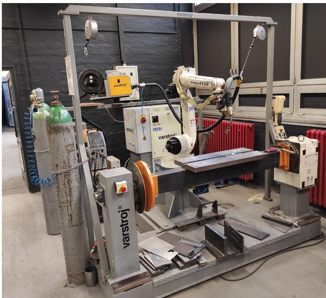
Slika 11. Robotska stanica Almega OTC AX V6
