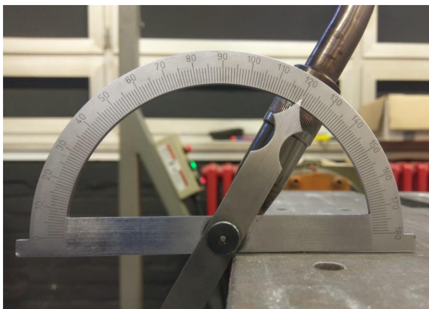
Slika 15. Određivanje kuta nagiba pištolja za zavarivanje
