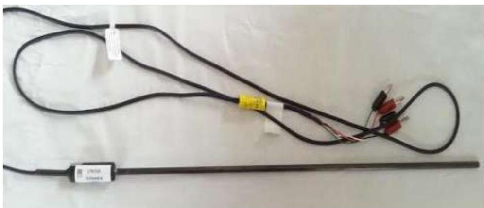
**Slika 7. Platinski otpornički termometri**
