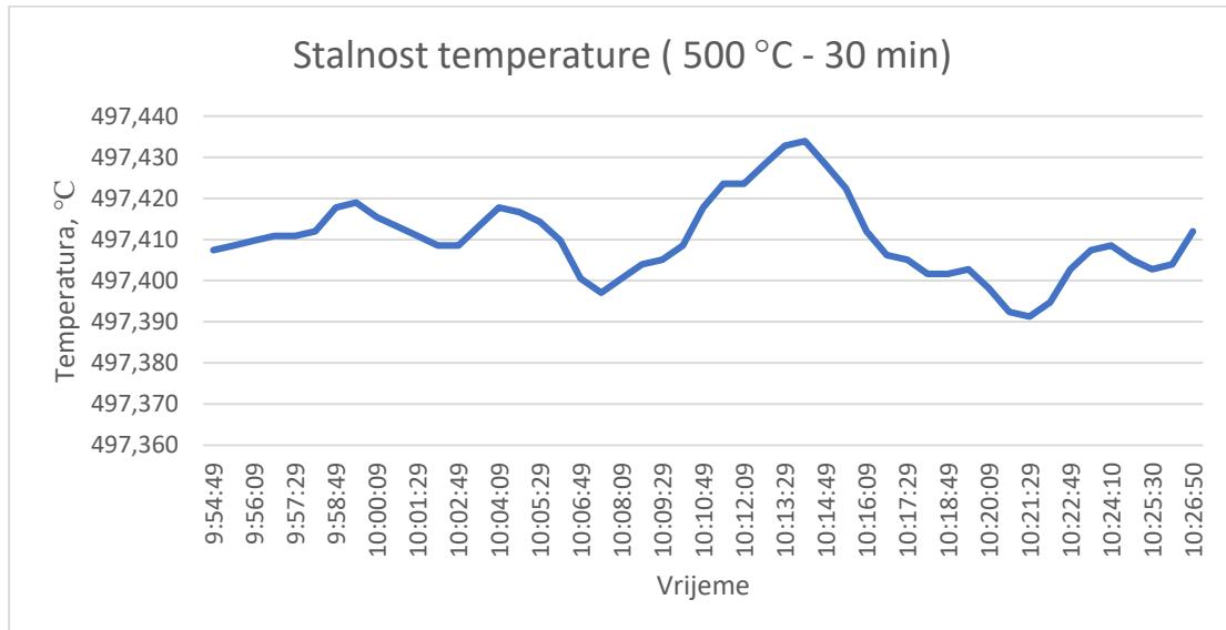
Slika 15. 30 minutna stalnost temperature pri 500 °C
