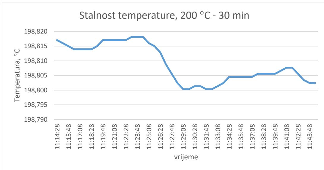
**Slika 13. 30 minutna stalnost temperature pri 200 °C**
