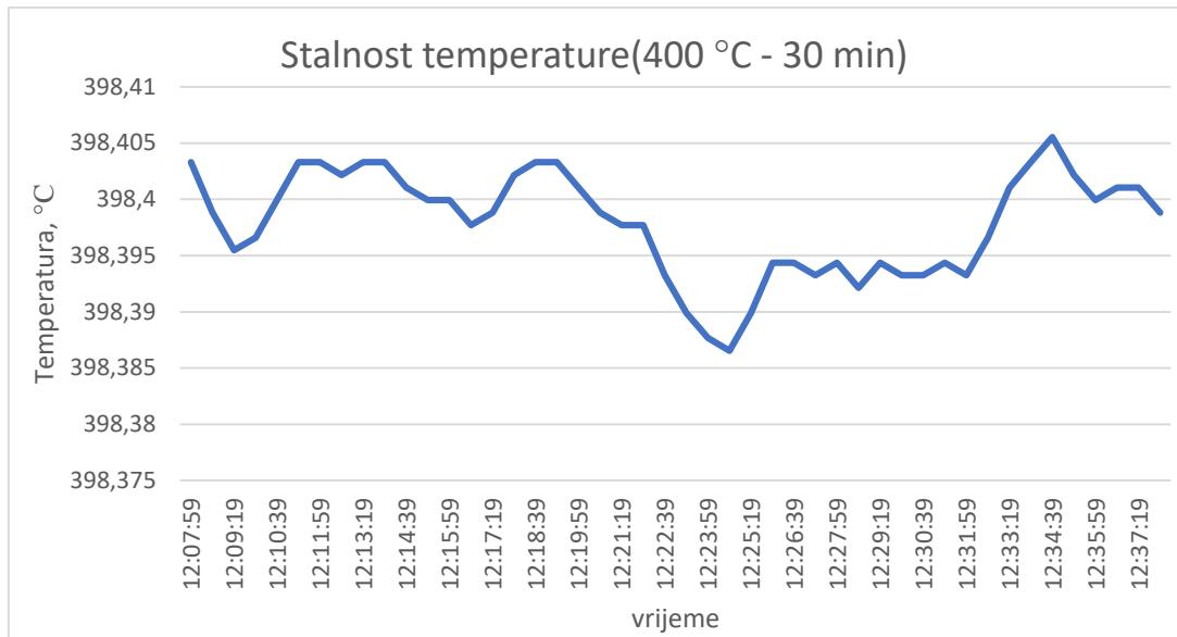
Slika 14. 30 minutna stalnost temperature pri 400 °C
