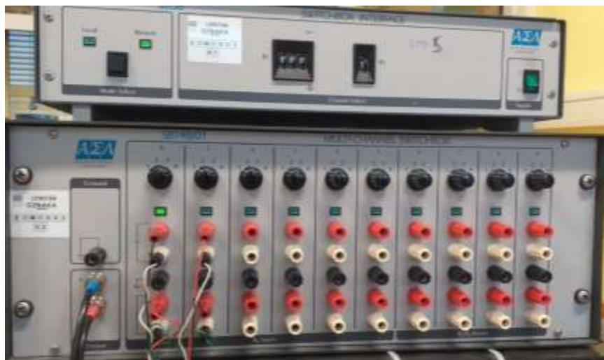
Slika 9. Multiplexor sa spojenim termometrima
