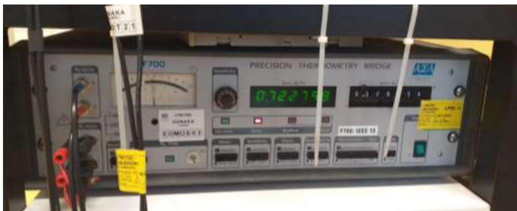
Slika 8. Termometrijski otpornički most
