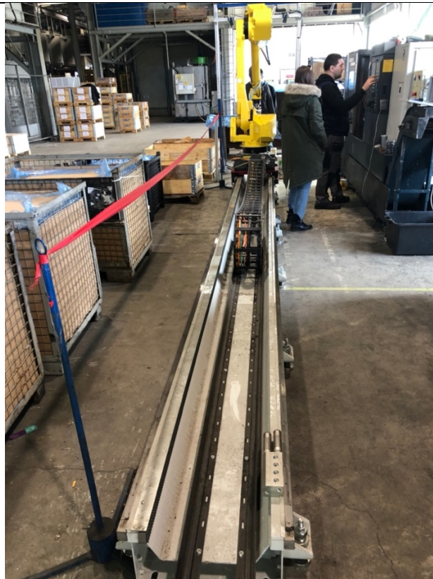
Slika 42. Pokretna traka koja omogućuje kretanje robota između strojeva
