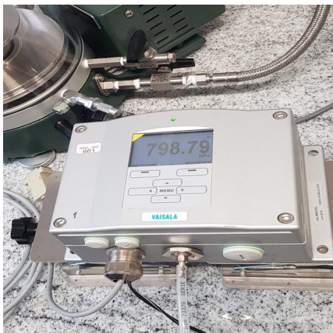
Slika 23. Digitalni barometar Vaisala, PTB330
