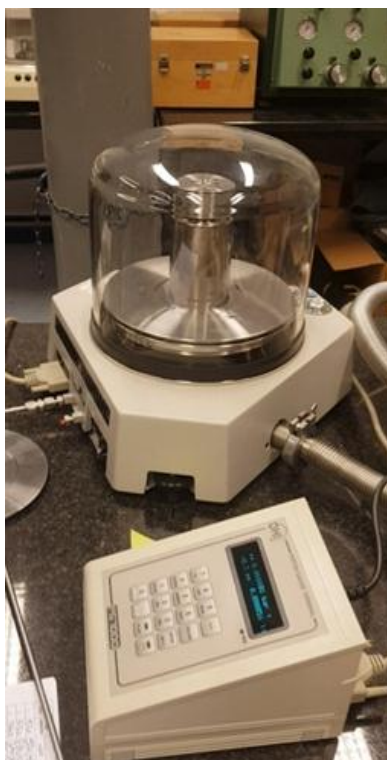
Slika 27. Tlačna vaga TLVAG-09
