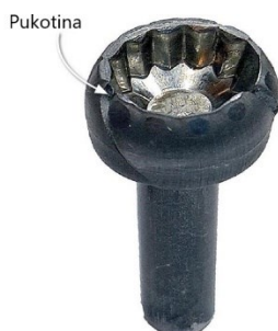
Slika 45. Površinska pukotina nastala tijekom hladnog kovanja [21]
