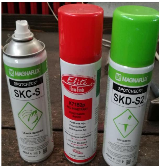
**Slika 31. Sredstva korištena za ispitivanje penetrantima**
