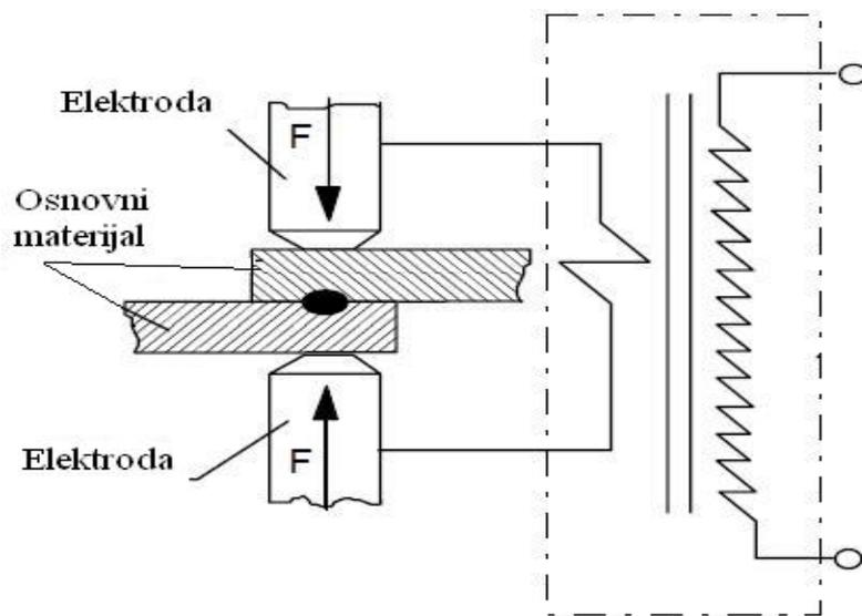
Slika 25. Shematski prikaz elektrotopnog točkastog zavarivanja [32]
