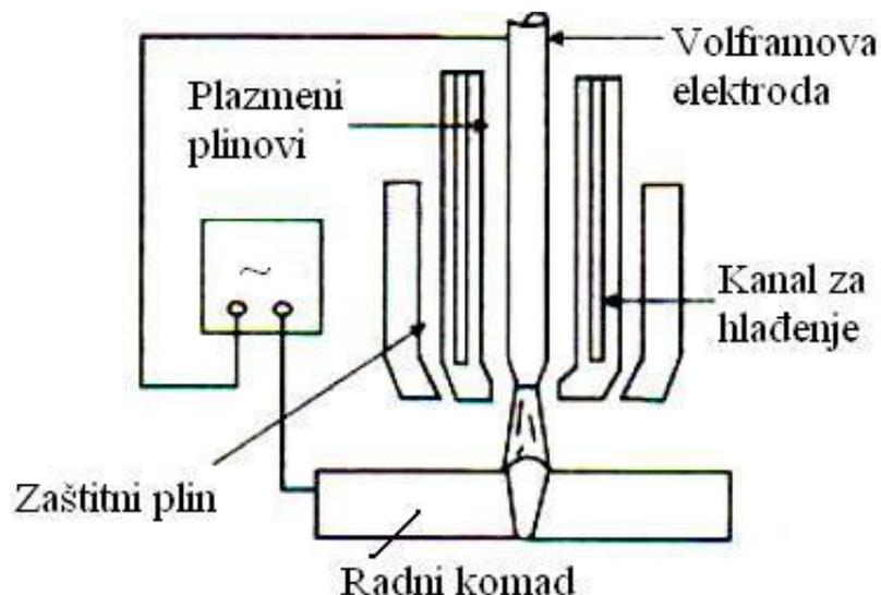
**Slika 24. Shematski prikaz plazma postupka zavarivanja [14]**
