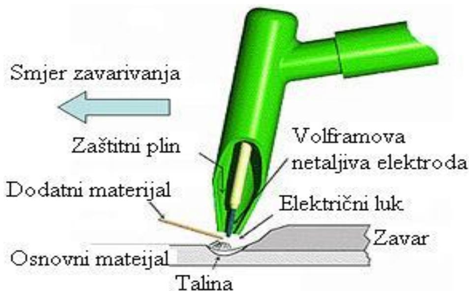
**Slika 21. Shematski prikaz TIG postupka zavarivanja [28]**
