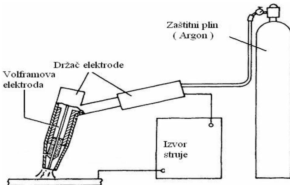
**Slika 22. Shematski prikaz uređaja za TIG postupak zavarivanja [29]**
