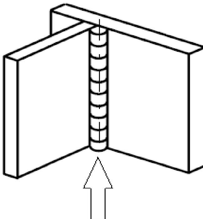
Slika 28. Položaj uzorka te smjer zavarivanja [36]
