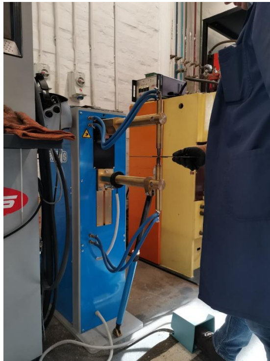
Slika 49 Zavarivanje ispitnih uzoraka
