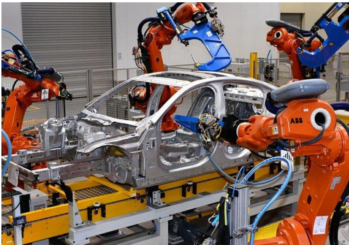
Slika 4 Robotizirano zavarivanje karoserije automobila [6]
