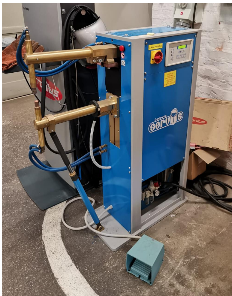
Slika 42 Uređaj za elektrootporno točkasto zavarivanje TV-15 PKS
