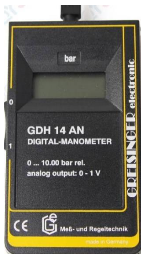
Slika 31. Digitalni manometar Greisinger digital manometer GDH 14
