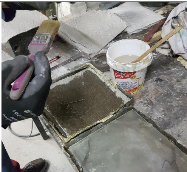
Slika 14. Ručno polaganje u kalup
