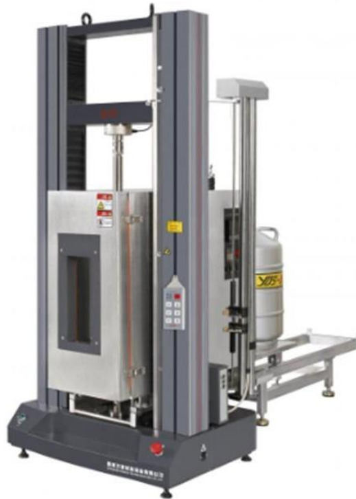
Slika 3.8. Komora za ohlađivanje ugrađena na kidalicu [5]
