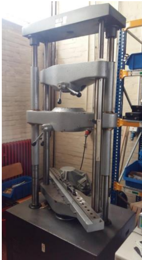
Slika 4.2. Hidraulična kidalica WPM EU 40 MOD
