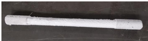
Slika 4.9. Epruveta hladena u tekućem dušiku
