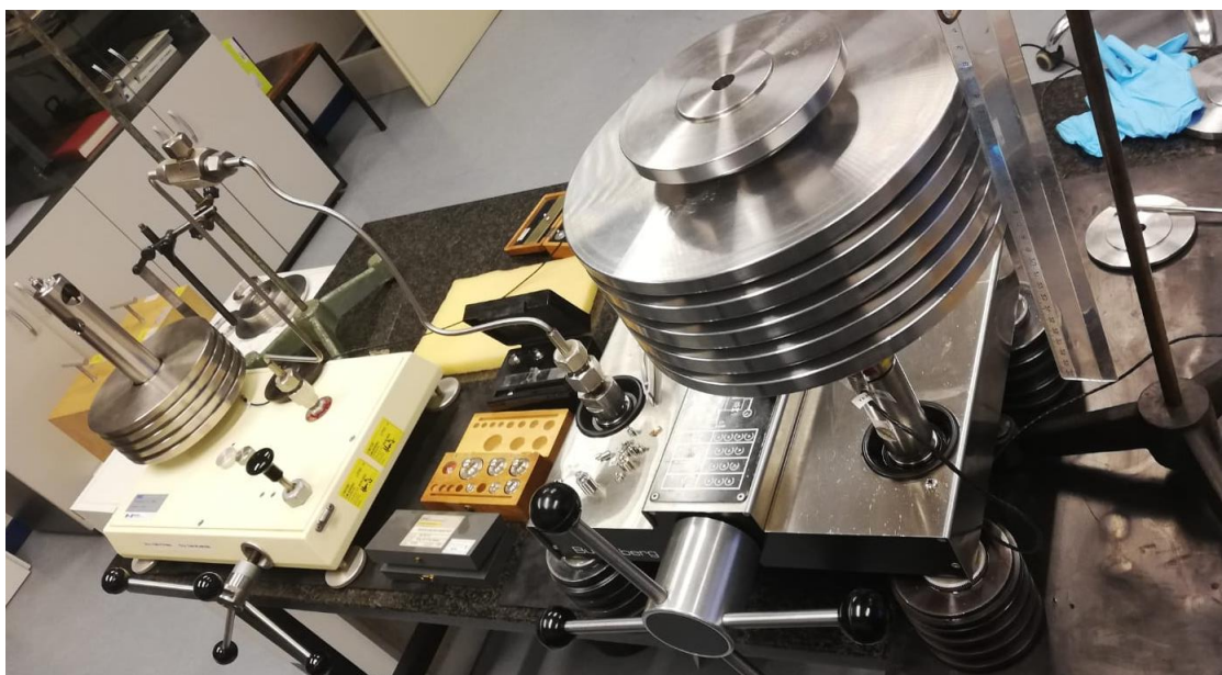
Slika 11. Sklop ispitivane i etalonske vage
