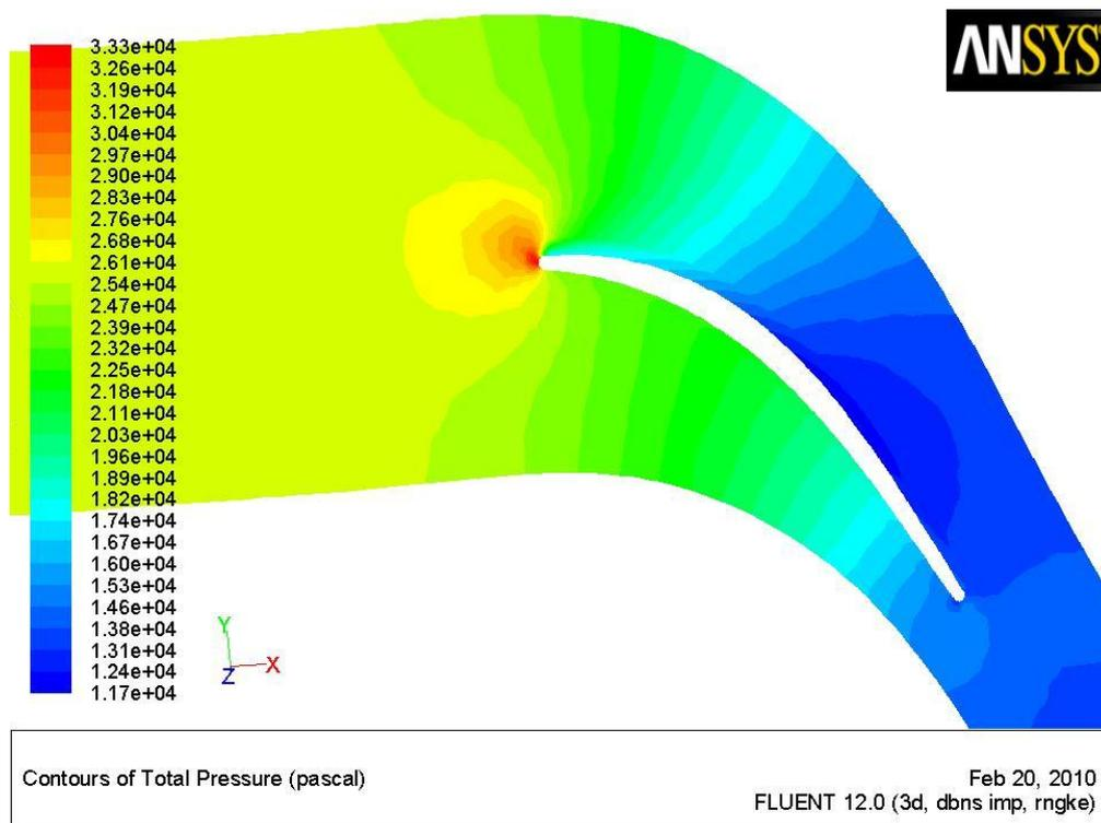
Slika 6.20. Prikaz raspodjele totalnog tlaka
