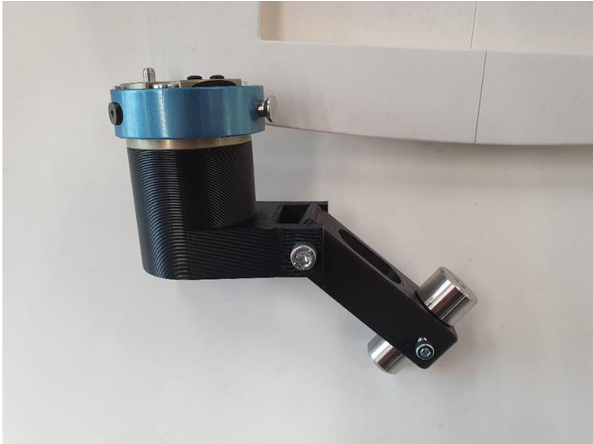
Slika 29. 3D print konstruiranog modularnog alata
