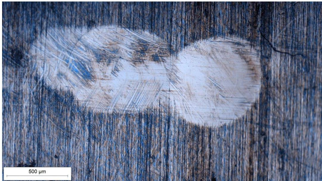
Slika 7.23 Prikaz traga trošenja nakon ispitivanja tribopar „100Cr6 – TiN/TiCN prevučeno“
