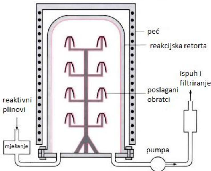
Slika 4.3 Shematski prikaz uređaja za CVD postupak [17]
