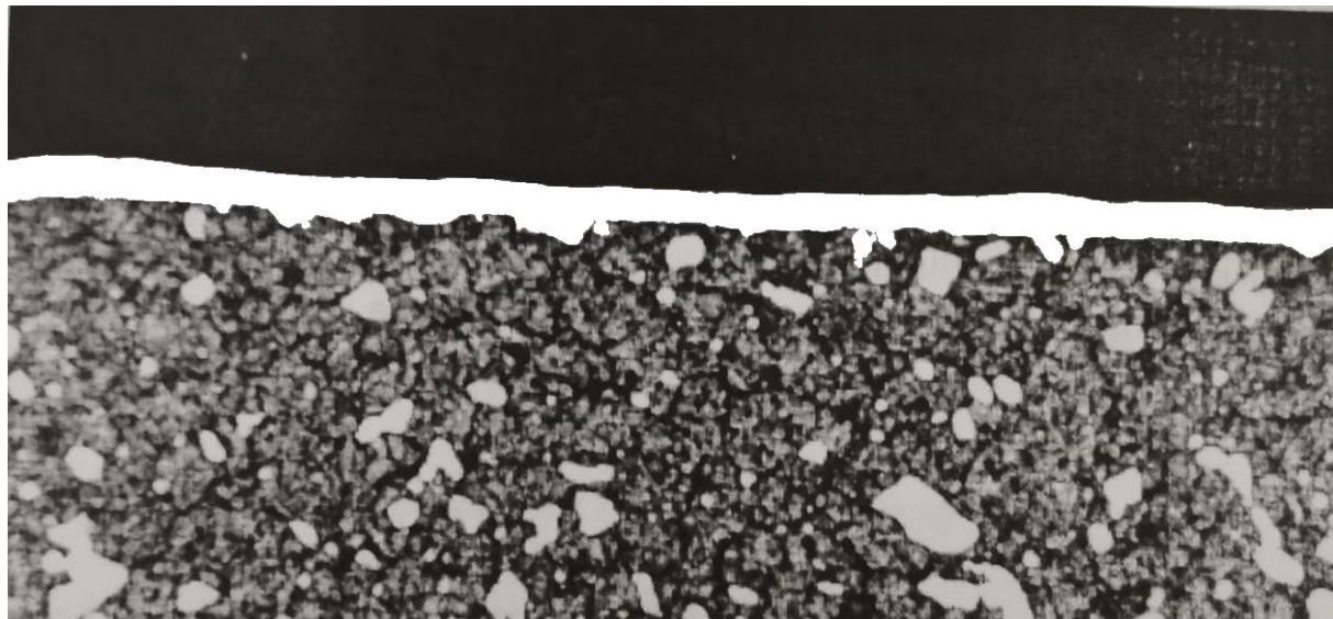
Slika 4.1 Presjek prevlake TiC na alatnom čeliku [9]
