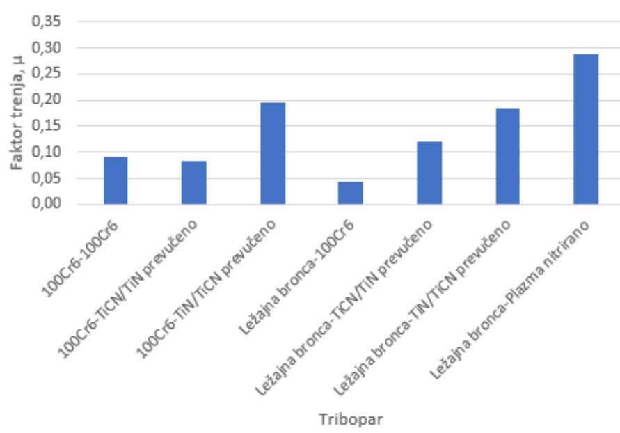
Slika 7.16 Usporedba faktora trenja ispitivanje s dodirom u točci
