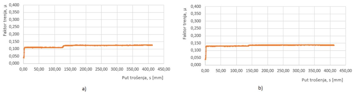
Slika 7.27 a) Ovisnost faktora trenja o putu trošenja za tribopar „ležajna bronca - TiCN/TiN prevučeno“ dodir u točci b) Ovisnost faktora trenja o putu trošenja za tribopar „ležajna bronca – TiCN/TiN prevučeno“ dodir u liniji
