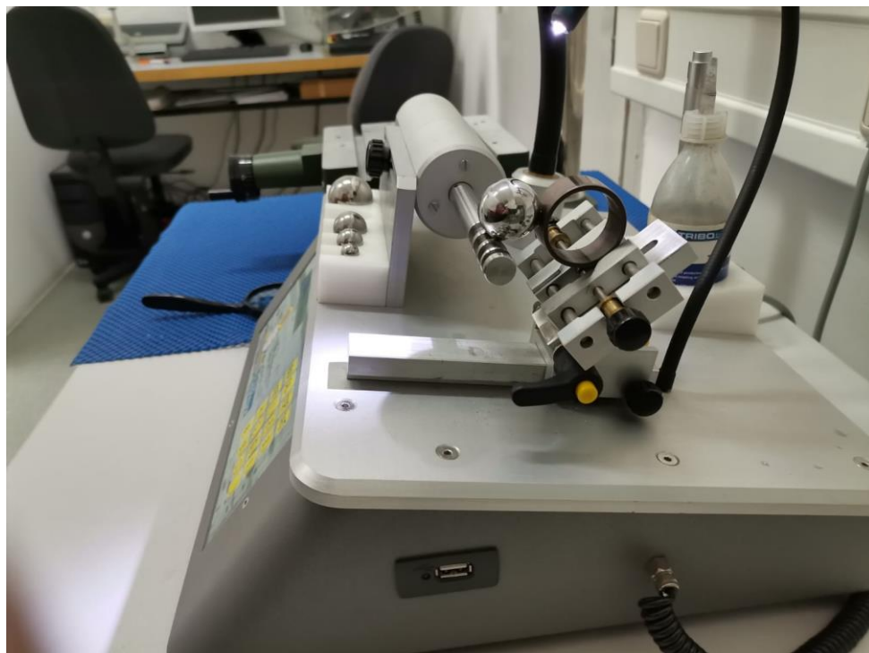
Slika 7.11 Ispitivanje debljine TiN/TiCN prevlake kalotestom
