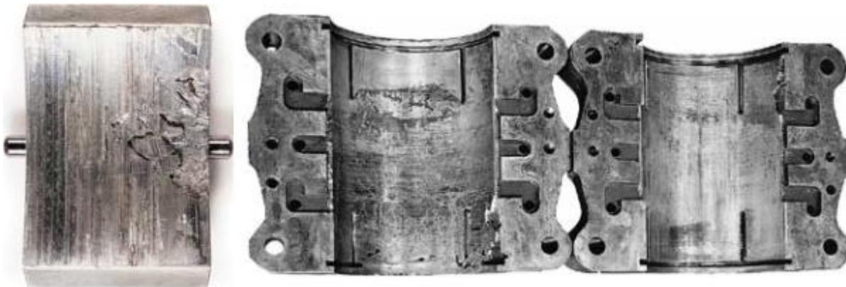
Slika 2.9 Oštećenja kliznog ležaja uslijed umora materijala [4]
