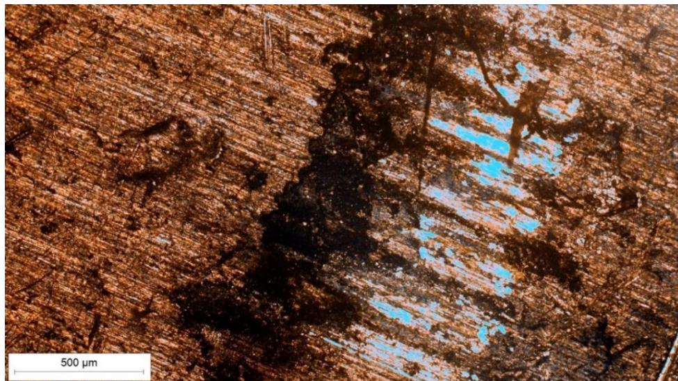
Slika 7.28 Prikaz traga trošenja nakon ispitivanja tribopar „ležajna bronca - TiCN/TiN prevučeno“ dodir u točci
