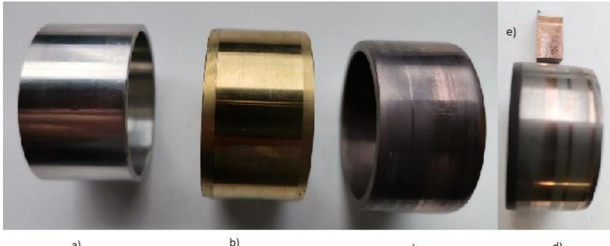
Slika 7.37 a) Prsten kliznog ležaja neprevučeni čelik DIN 100Cr6, b) Prsten kliznog ležaja prevučen TiCN/TiN prevlakom PACVD postupkom, c) Prsten kliznog ležaja prevučen TiN/TiCN prevlakom PACVD postupkom, d) Prsten kliznog ležaja nitriran u plazmi, e) Uzorak kliznog ležaja od ležajne bronce
