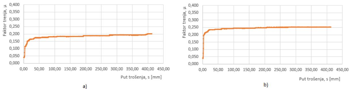
**Slika 7.30 a) Ovisnost faktora trenja o putu trošenja za tribopar „ležajna bronca – TiN/TiCN prevučeno“ dodir u točci b) Ovisnost faktora trenja o putu trošenja za tribopar „ležajna bronca – TiN/TiCN prevučeno“ dodir u liniji**
