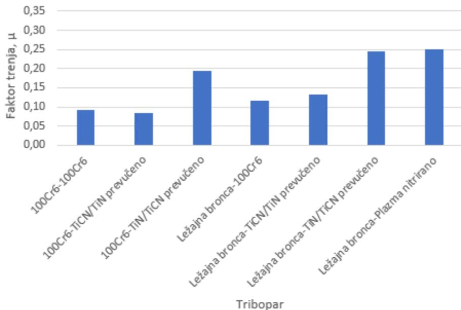
**Slika 7.17 Usporedba faktora trenja ispitivanje s dodirom u liniji**
