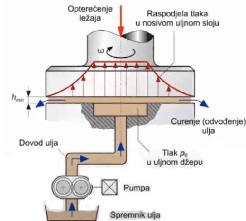
Slika 2.3 Princip rada kliznog ležaja s hidrostatičkim podmazivanjem [2]
