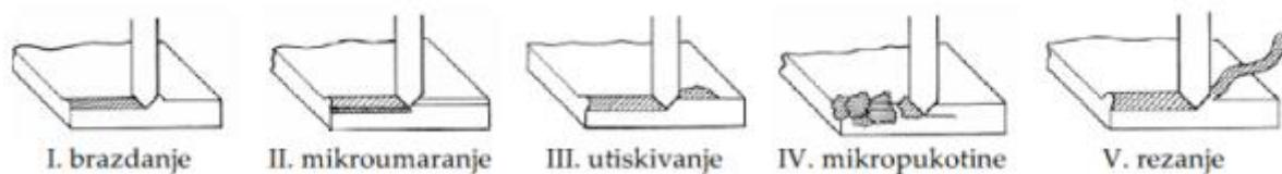
Slika 2.7 Načini abrazijskog trošenja [3]
