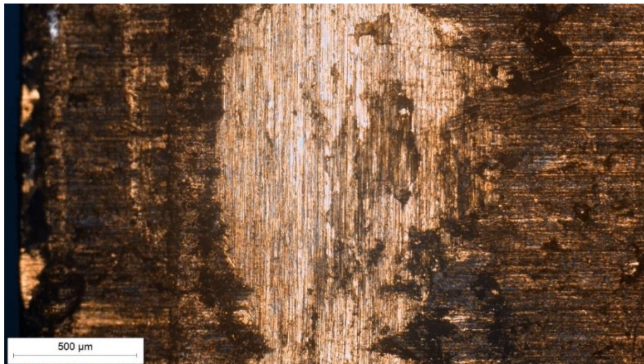
Slika 7.31 Prikaz traga trošenja nakon ispitivanja tribopar „ležajna bronca – TiN/TiCN prevučeno“ dodir u točki
