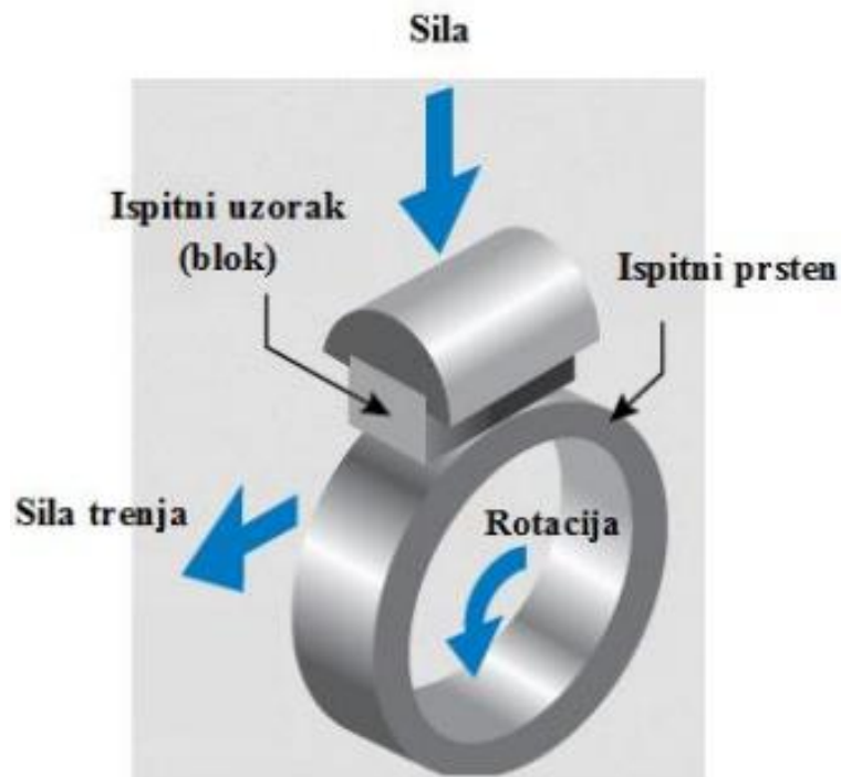
Slika 5.7 Shematski prikaz metode Blok na prstenu [29]
