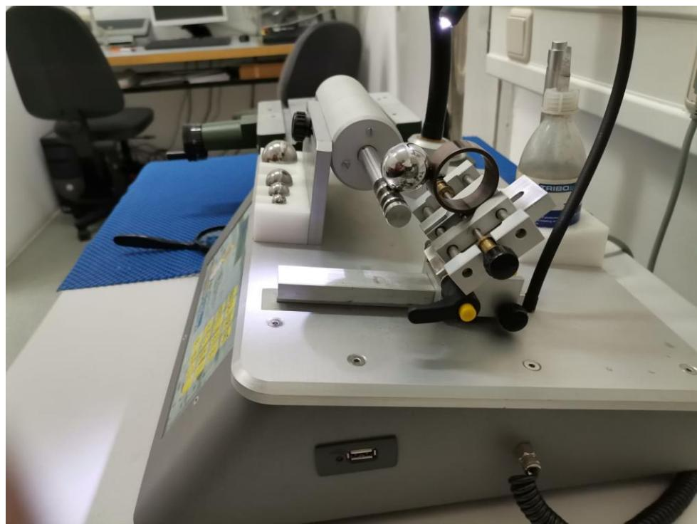
Slika 7.11 Ispitivanje debljine TiN/TiCN prevlake kalotestom
