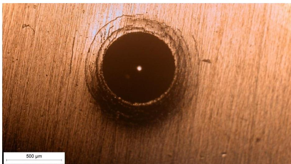
Slika 7.6 Ispitivanje 1, mjesto utiskivanja indentora u TiCN/TiN prevlaku
