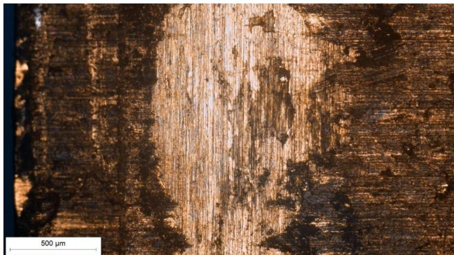
**Slika 7.31 Prikaz traga trošenja nakon ispitivanja tribopar „ležajna bronca – TiN/TiCN prevučeno“ dodir u točci**
