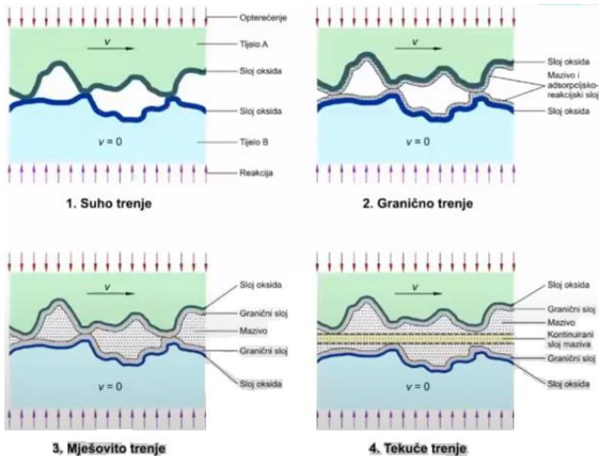
Slika 2.2 Vrste trenja ovisno o količini maziva na površinama u dodiru [2]
