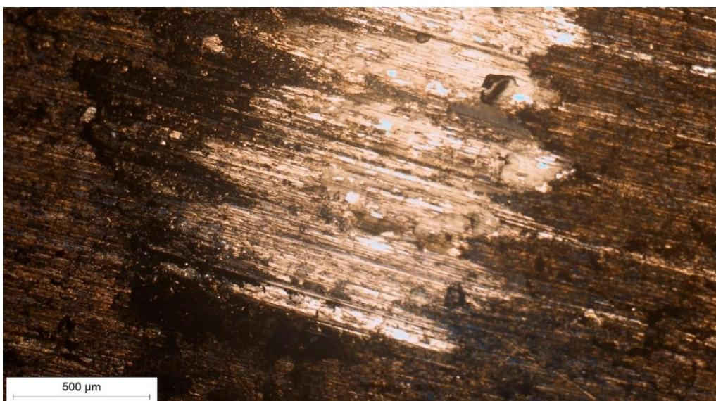
Slika 7.26 Prikaz traga trošenja nakon ispitivanja tribopar „ležajna bronca - 100Cr6“ dodir u liniji
