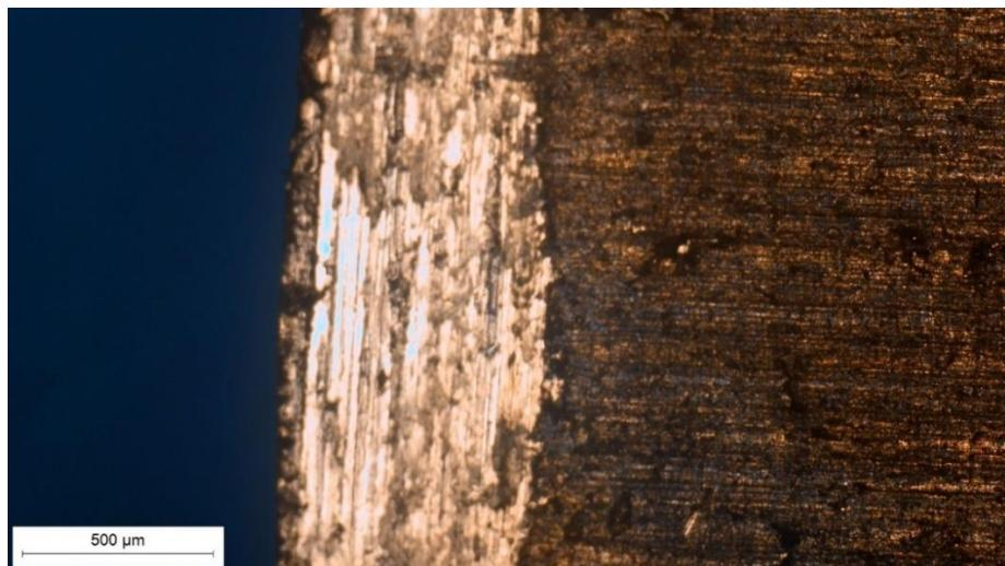
**Slika 7.34 Prikaz traga trošenja nakon ispitivanja tribopar „ležajna bronca - Plazma nitrirano“ dodir u točci**
