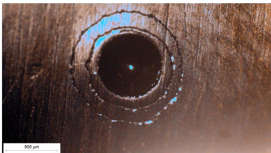
Slika 7.8 Ispitivanje 1, mjesto utiskivanja indentora u TiN/TiCN prevlaku
