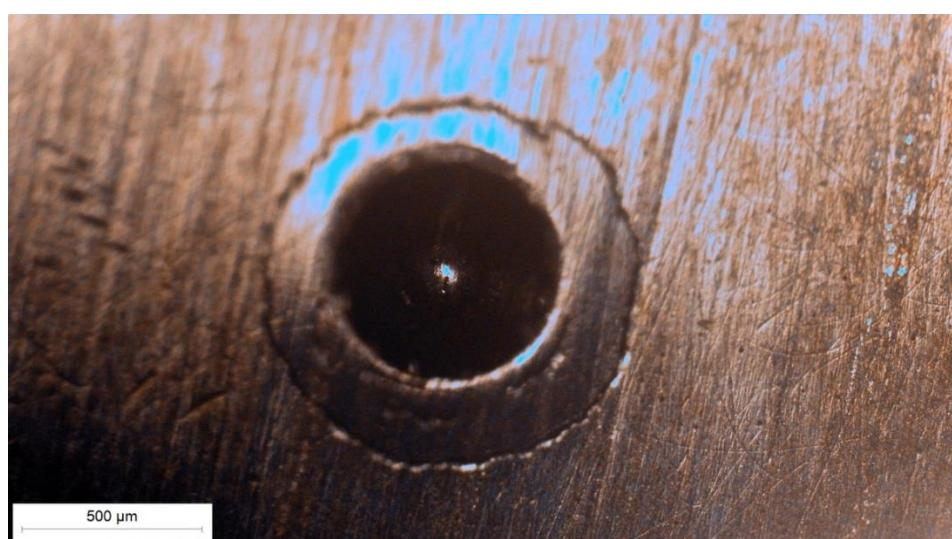
Slika 7.9 Ispitivanje 2, mjesto utiskivanja indentora u TiN/TiCN prevlaku
