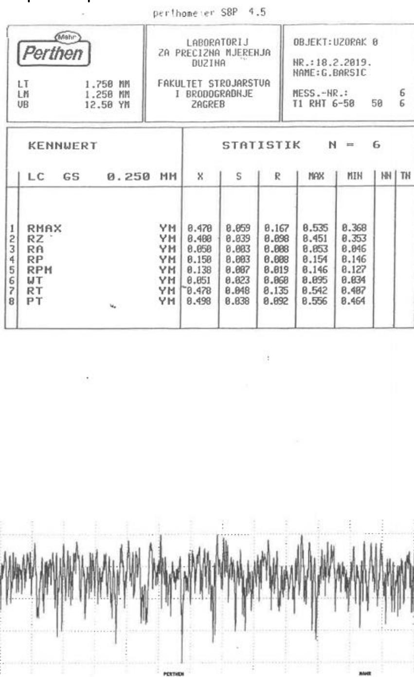
Slika 9.1 Profil hrapavosti i parametri neprevučenog prstena kliznog ležaja od čelika DIN 100Cr6
