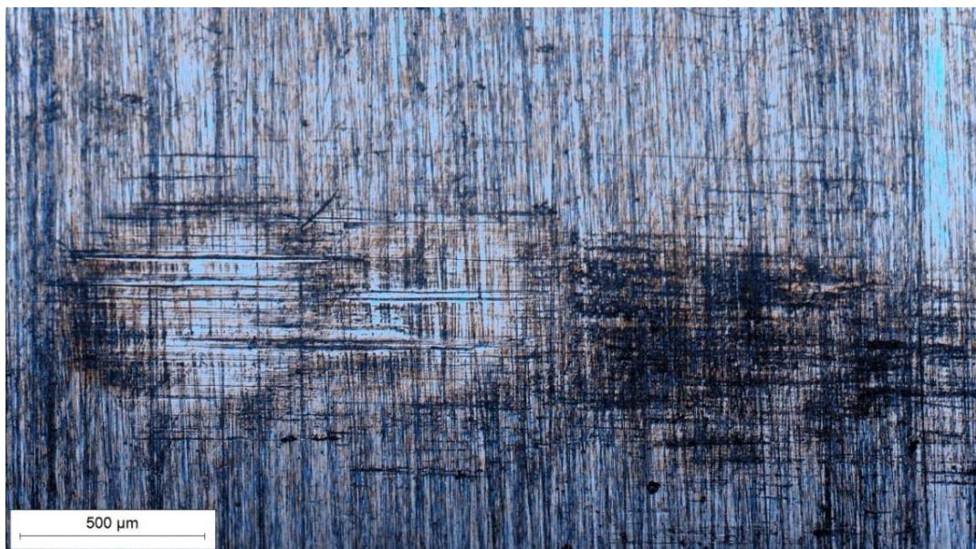
Slika 7.19 Prikaz traga trošenja nakon ispitivanja tribopar „100Cr6 - 100Cr6“
