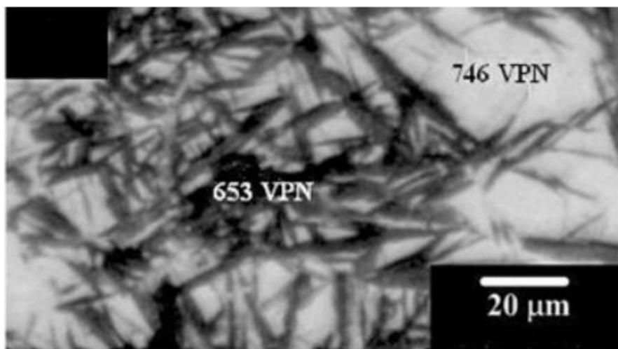
Slika 3.6 Mikrotvrdića nakon "Austempering" postupka [12]
