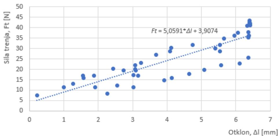
Slika 7.14 Kalibracija opruge uređaja za ispitivanje faktora trenja
