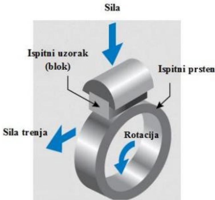
Slika 5.7 Shematski prikaz metode Blok na prstenu [29]
