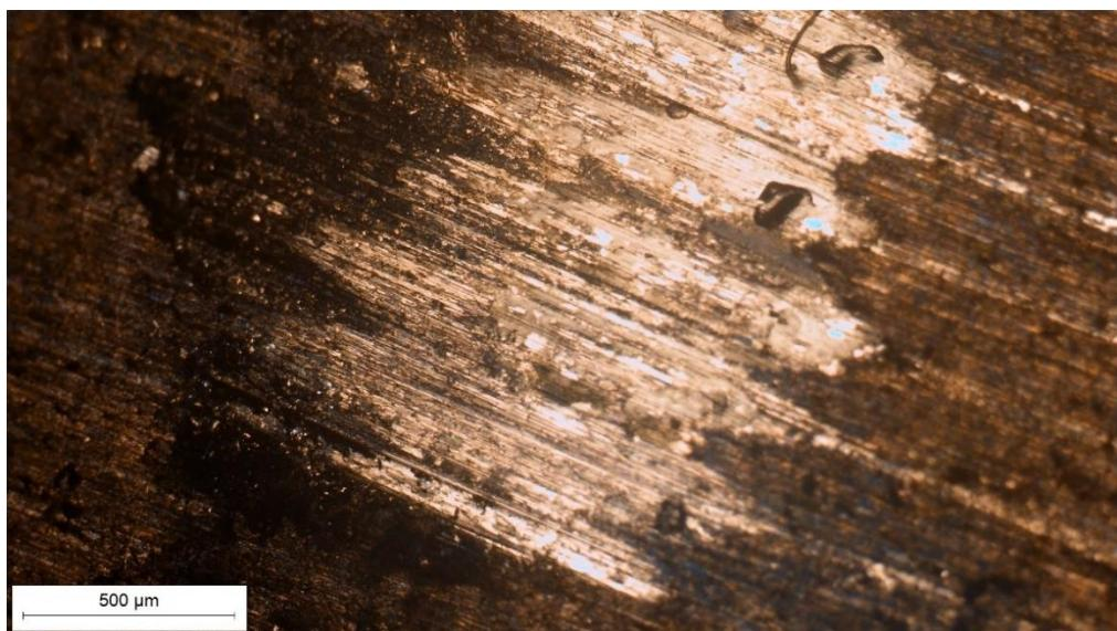
Slika 7.25 Prikaz traga trošenja nakon ispitivanja tribopar „ležajna bronca - 100Cr6“ dodir u točci
