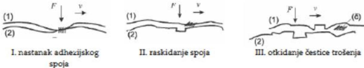
Slika 2.8 Faze adhezijskog trošenja [3]
