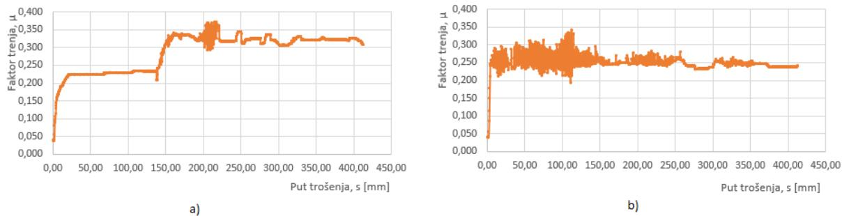
**Slika 7.33 a) Ovisnost faktora trenja o putu trošenja za tribopar „ležajna bronca - Plazma nitrirano“ dodir u točci b) Ovisnost faktora trenja o putu trošenja za tribopar „ležajna bronca - Plazma nitrirano“ dodir u liniji**
