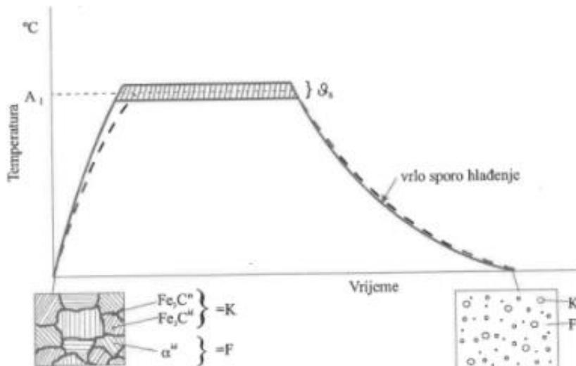
Slika 3.3 Sferoidizacijsko žarenje [9]
