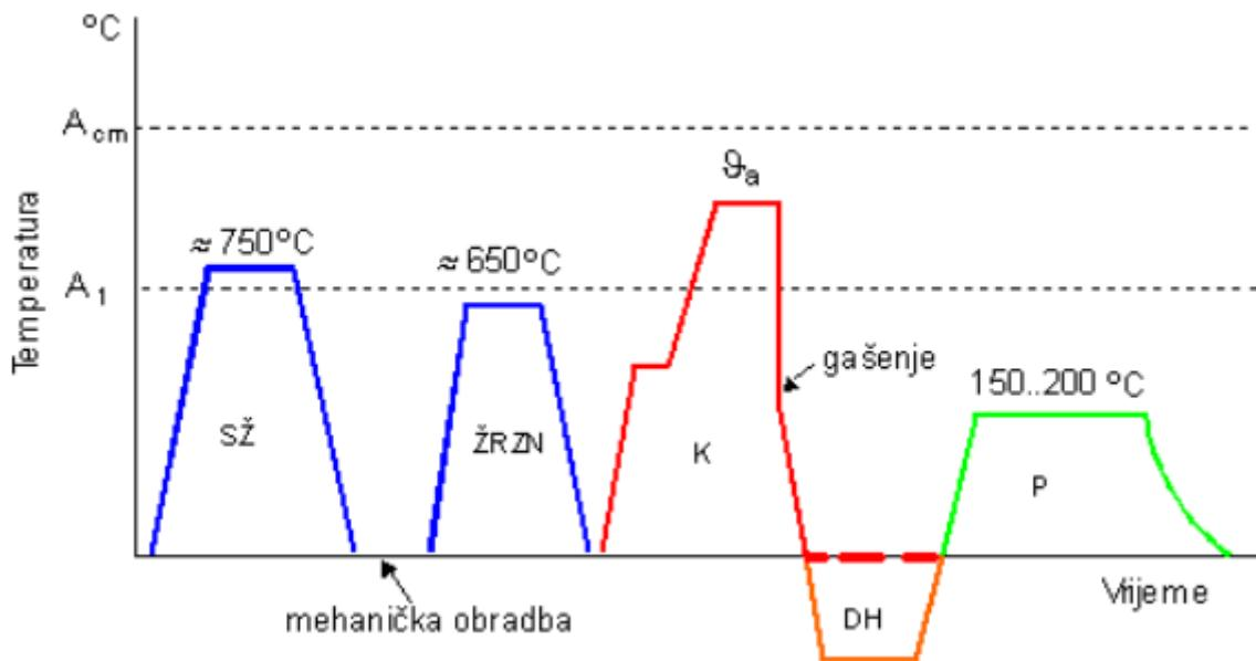
Slika 3.1 Graf toplinske obrade čelika DIN 100Cr6 [3]
