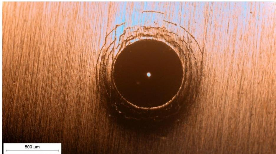
Slika 7.7 Ispitivanje 2, mjesto utiskivanja indentora u TiCN/TiN prevlaku
