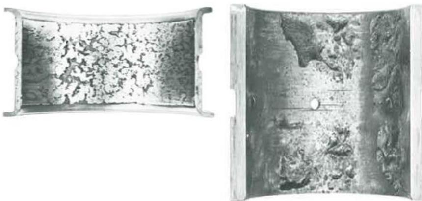
Slika 2.10 Oštećenja nastala djelovanjem korozije [5]
