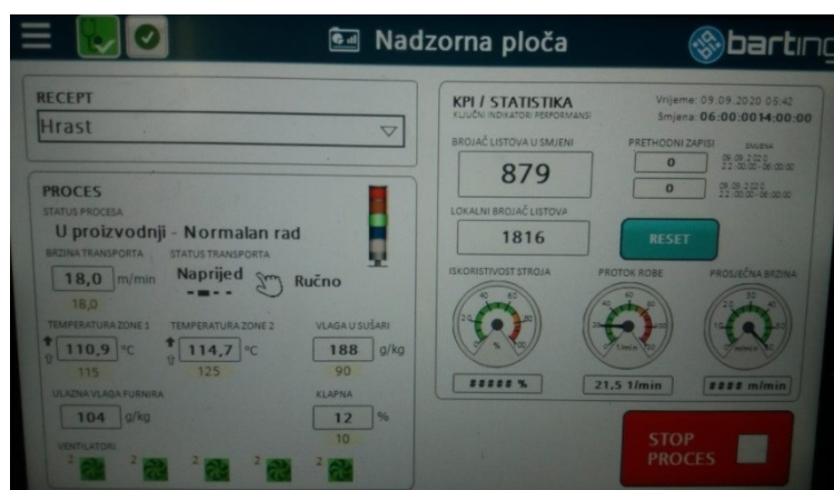
Slika 56. Prikaz prozora „Recept“ na HMI-u [23]
