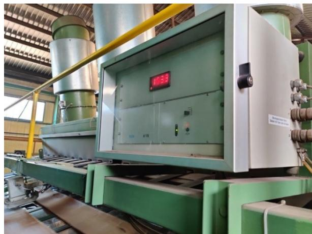
Slika 62. Senzor za mjerjenje ulazne vlažnosti furnira
