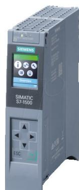
Slika 73. Siemens CPU S7-1511-1 PN [29]
