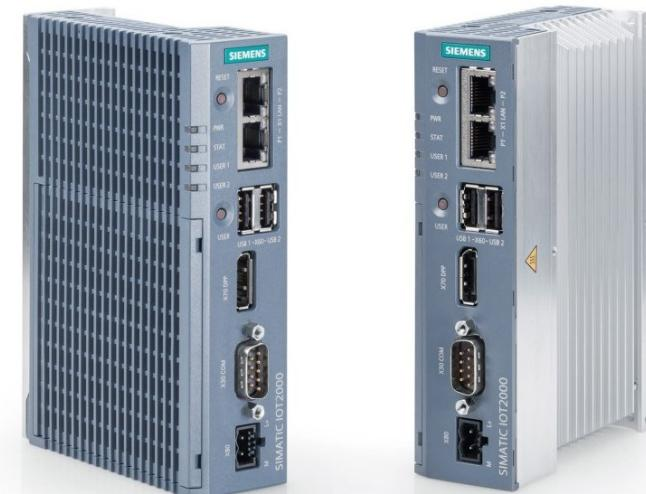
Slika 115. Siemens SIMATIC IOT2050 IIoT gateway [29]
