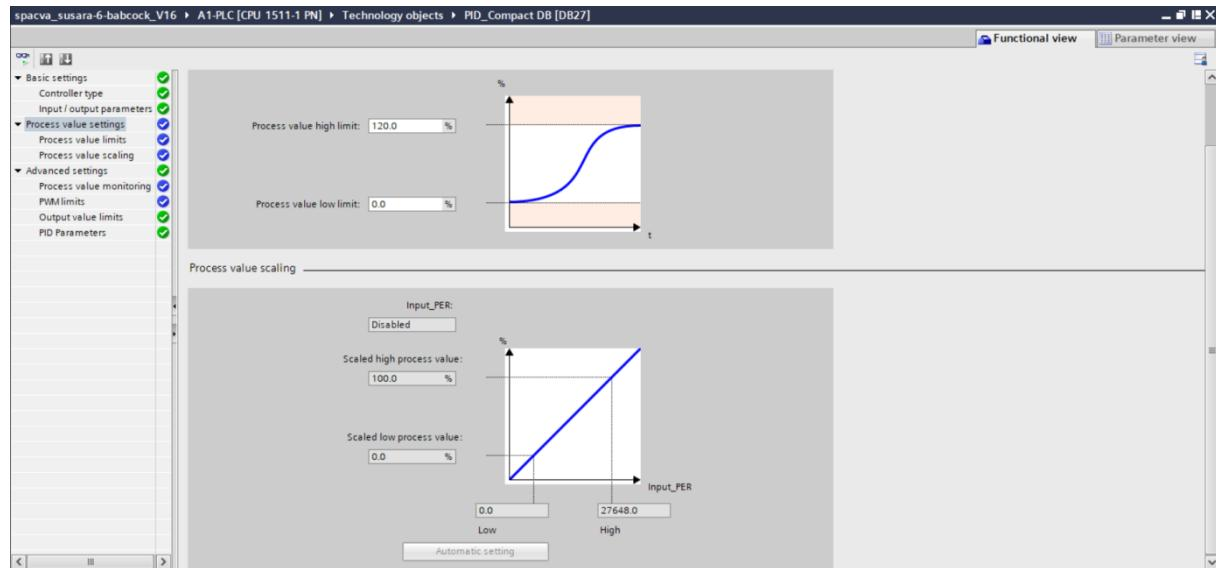
Slika 103. Procesne postavke za konfiguraciju PID regulatora
