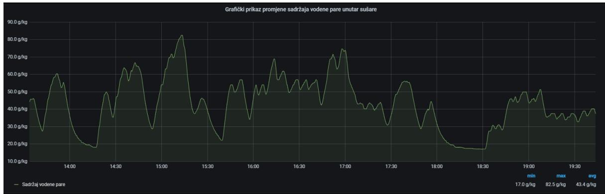
Slika 69. Prikaz promjene sadržaja vodene pare unutar sušare
