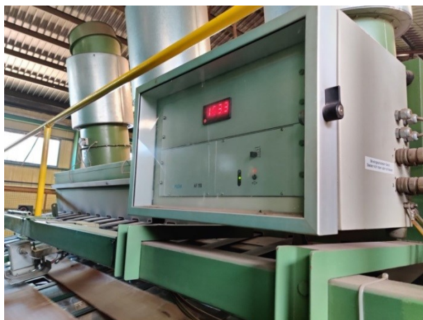
Slika 62. Senzor za mjerenje ulazne vlažnosti furnira
