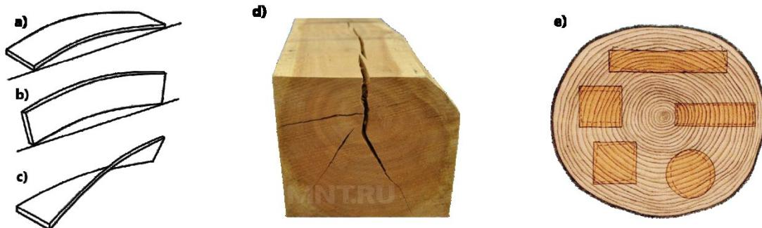
**Slika 1. Deformacije drveta nakon sušenja: a) izbočenost, b) sabljastost, c) vitoperost
