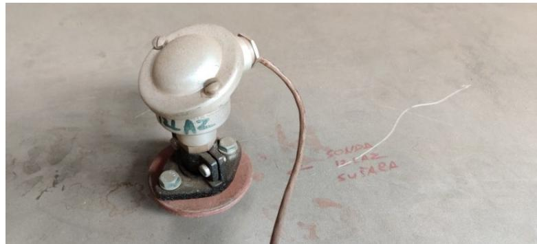
**Slika 64. Senzor za očitanje temperature unutar sušare – na bočnoj strani**
