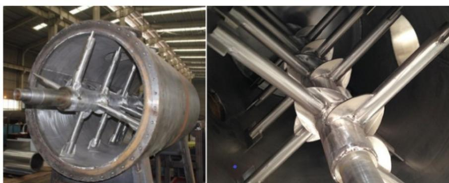
Slika 27. Prikaz mješalice unutar valjkaste vakuum sušare [10]
