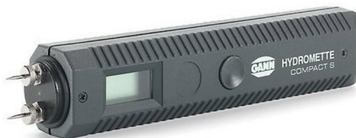
Slika 71. Uređaj za ručno mjerenje vlažnosti furnira [28]
