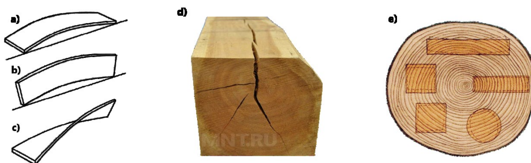
Slika 1. Deformacije drveta nakon sušenja: a) izbočenost, b) sabljastost, c) vitoperost d) čeon i površinske pukotine, e) promjene oblika
