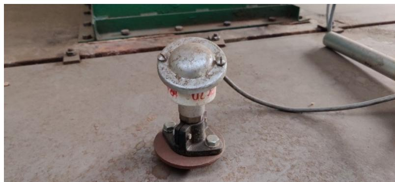
Slika 63. Senzor za očitanje temperature unutar sušare – na krovu sušare
