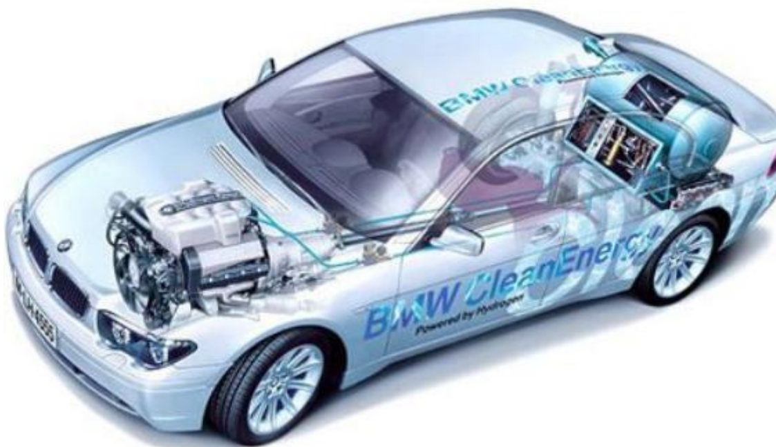
Slika 8. Shema unutarnjih dijelova Hydrogen 7 automobila [9]
