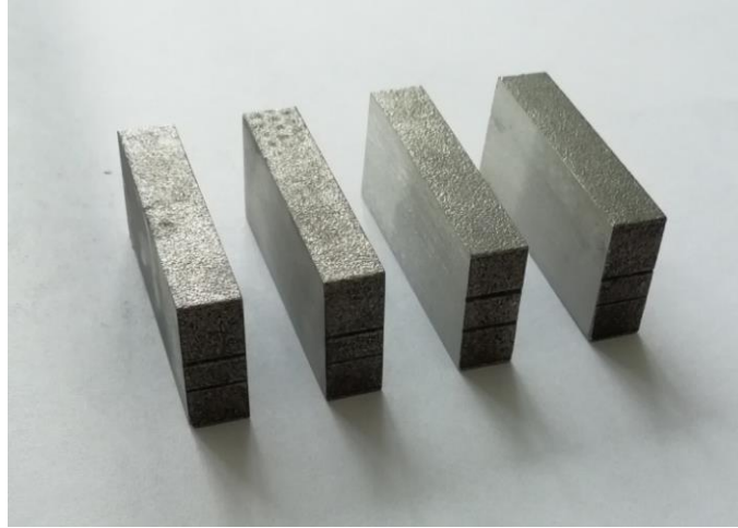
Slika 23. Izrezani ispitni uzorci
