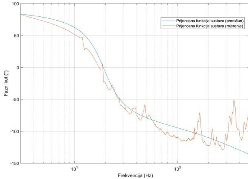
**Slika 6.9** Dijagram faznog kuta pri mjerjenju i za prigušeni sustav ( $c = 13,5 \text{ Ns/m}$ )
