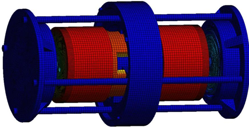
**Slika 3.3 Torzijska forma vibriranja**
