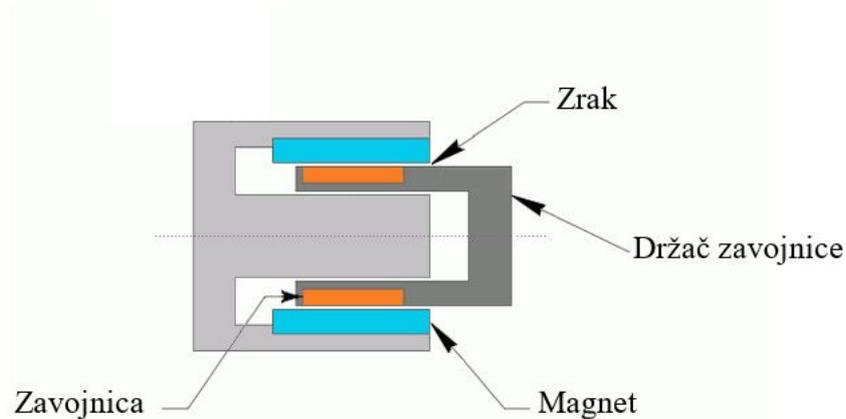
Slika 4.2 Shematski prikaz zavojnice i magneta
