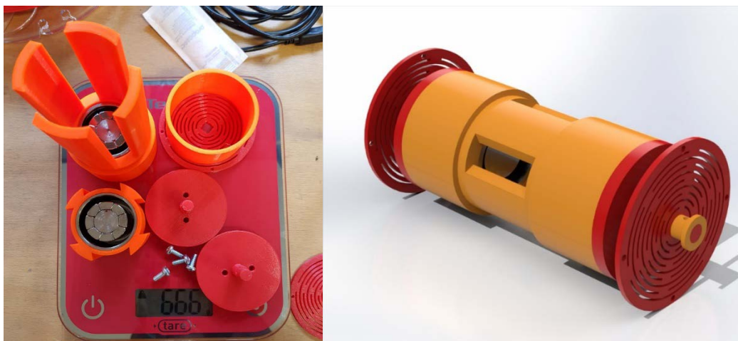
Slika 4.1 Masa pomičnih dijelova (lijevo) i CAD prikaz pomičnih dijelova
