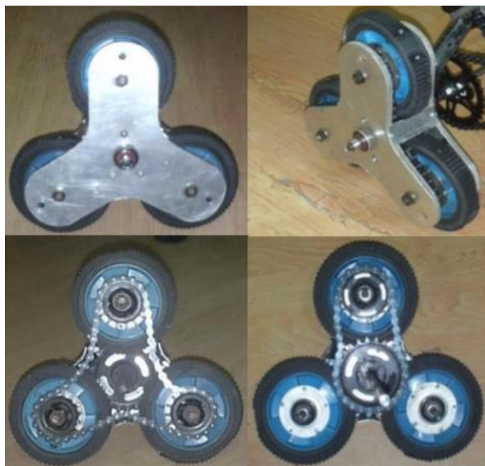
Slika 3.4. Sklop i pogon kotača u trokutnoj konfiguraciji[13]
