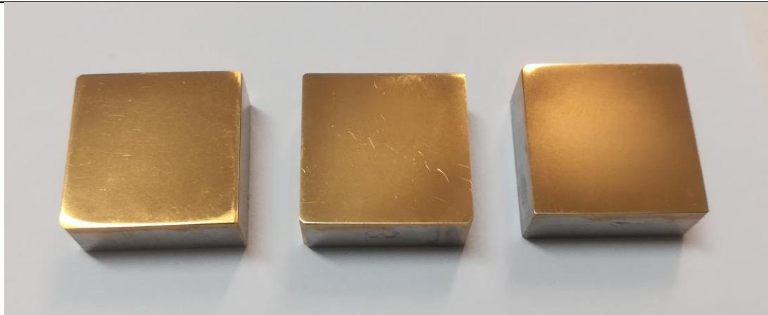
**Slika 23.** Uzorci prevučeni TiN prevlakom
