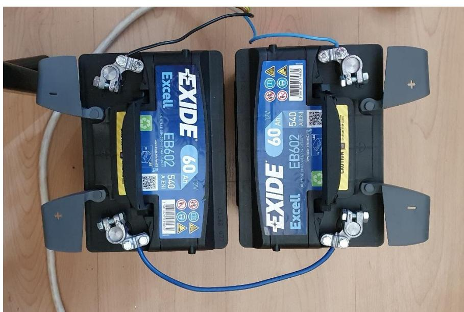
Slika 18 Napajanje motora
